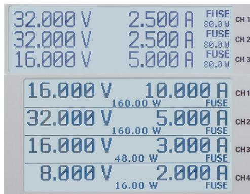
Abb. 4.7: HMP2030 / HMP4040 FUSE-Darstellung im Display
