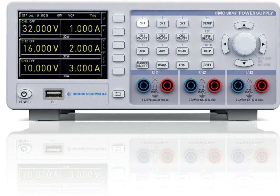
Arbitrary-Schritten, sowie ein für jeden Kanal einstellbarer Over-Voltage- und Over-Power-Schutz sind für Entwickler und Industrieanwender wichtig.
