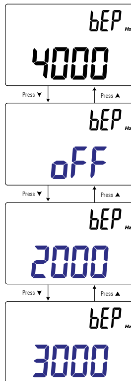
Figure 3-13 Modification de la fréquence du signal sonore
