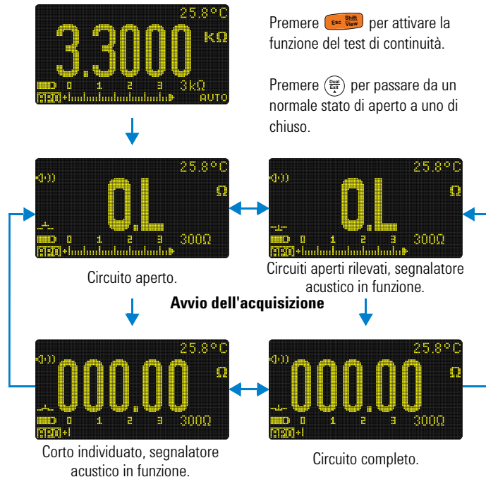
Figura 2-13 Operazione di continuità
