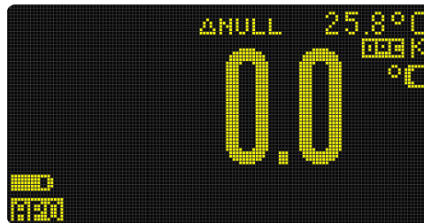
Figura 2-28 Misurazione della temperatura senza compensazione ambiente
