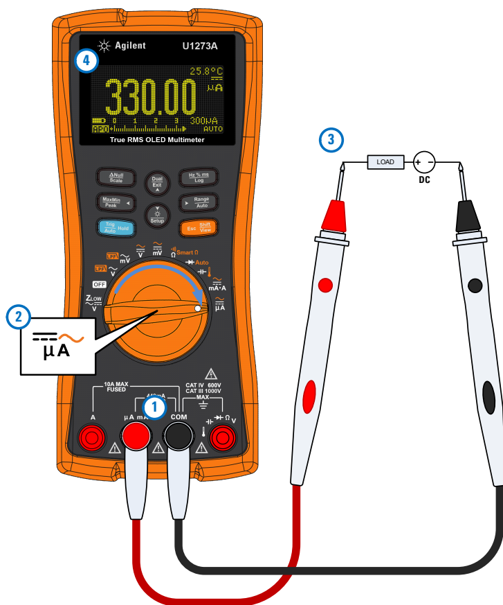
Figura 2-30 Misurazione della corrente continua
