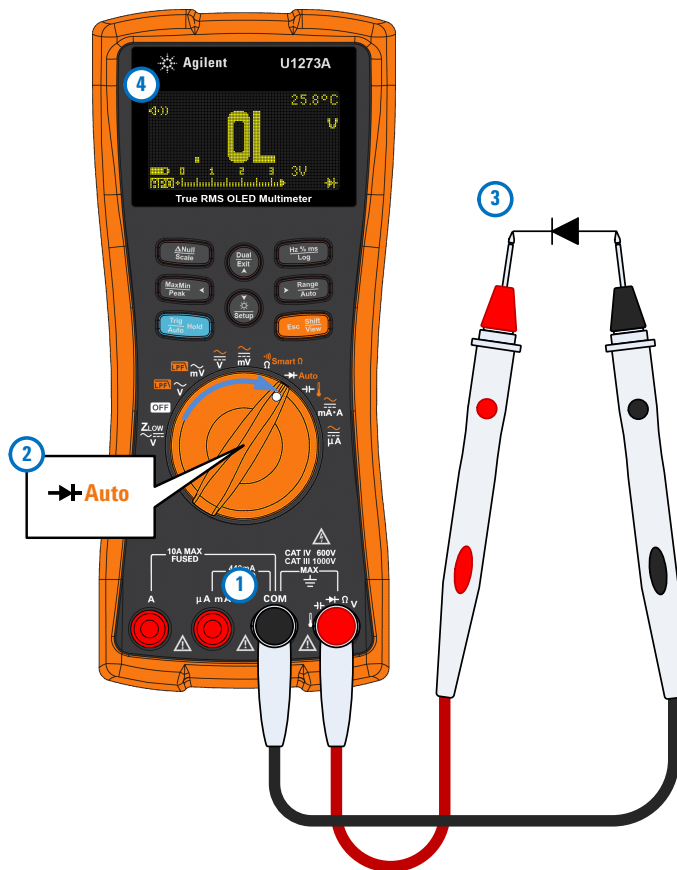
Figura 2-21 Misurazione di un diodo con modalità di polarizzazione inversa
