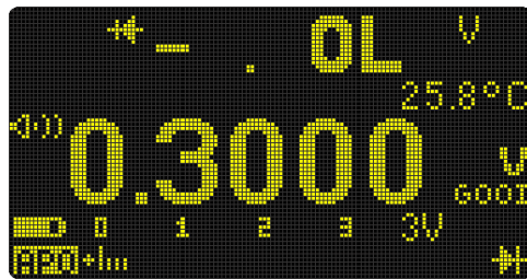
Figura 2-22 Visualizzazione dell'autodiiodo (GOOD, stato funzionante)
