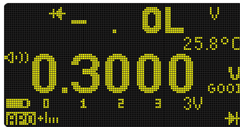
Abbildung 2-22 Anzeige für Automatische Diode (Status „GOOD“)
