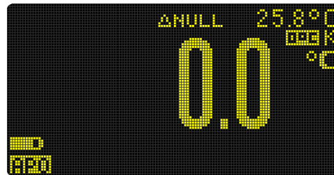
Abbildung 2-28 Temperaturmessungen ohne Umgebungskompensation
