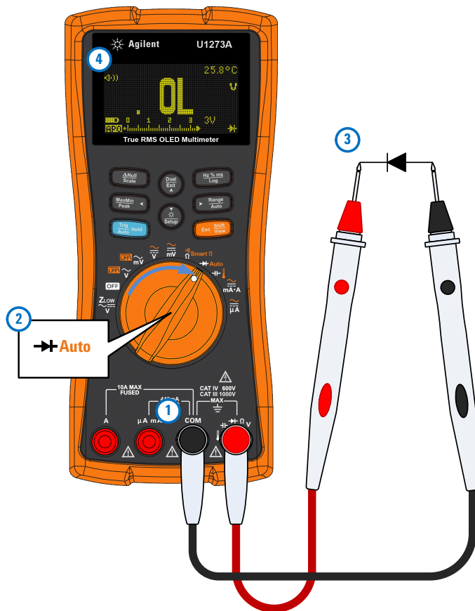
Abbildung 2-21 Prüfen einer Sperrvorspannungsdiode
