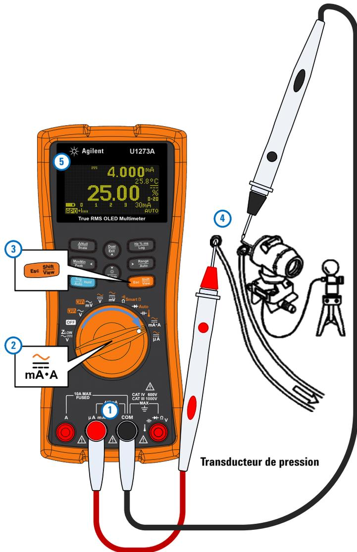
Figure 2-34 Mesure d'un courant CC à l'aide de l'échelle de pourcentage 0-20 mA
