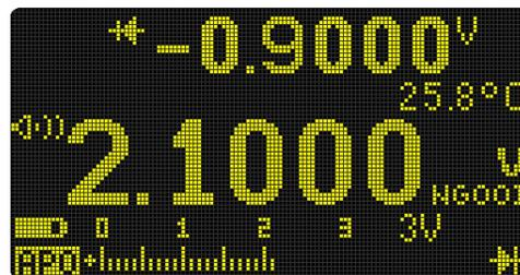
Figure 2-23 Affichage de la fonction de diode automatique (état NGOOD)
