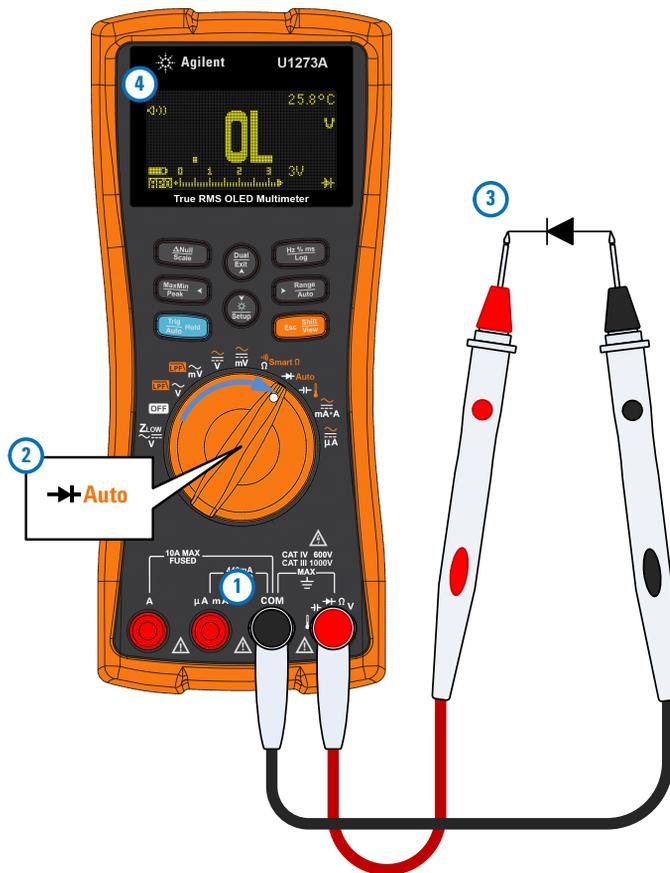
Figure 2-21 Test de tension de polarisation inverse d'une diode
