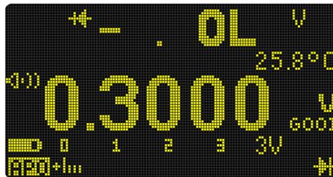
Figure 2-22 Affichage de la fonction de diode automatique (état GOOD)
