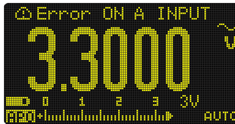
Figura 1-4 Exibição de aviso de entrada (A INPUT)
