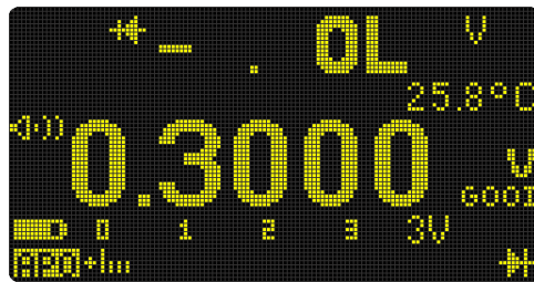
Figura 2-22 Exibição do diodo automático (status BOM - GOOD)
