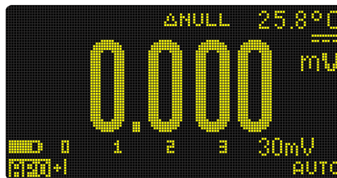
Figura 3-1 Exibição da função Null (nulo)
