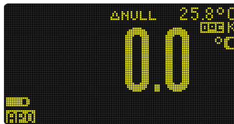
Figura 2-28 Medição de temperatura sem compensação de ambiente
