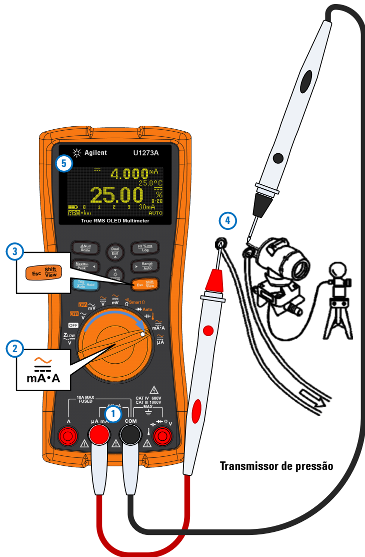
Figura 2-34 Medir a corrente CC usando a escala % 0–20 mA
