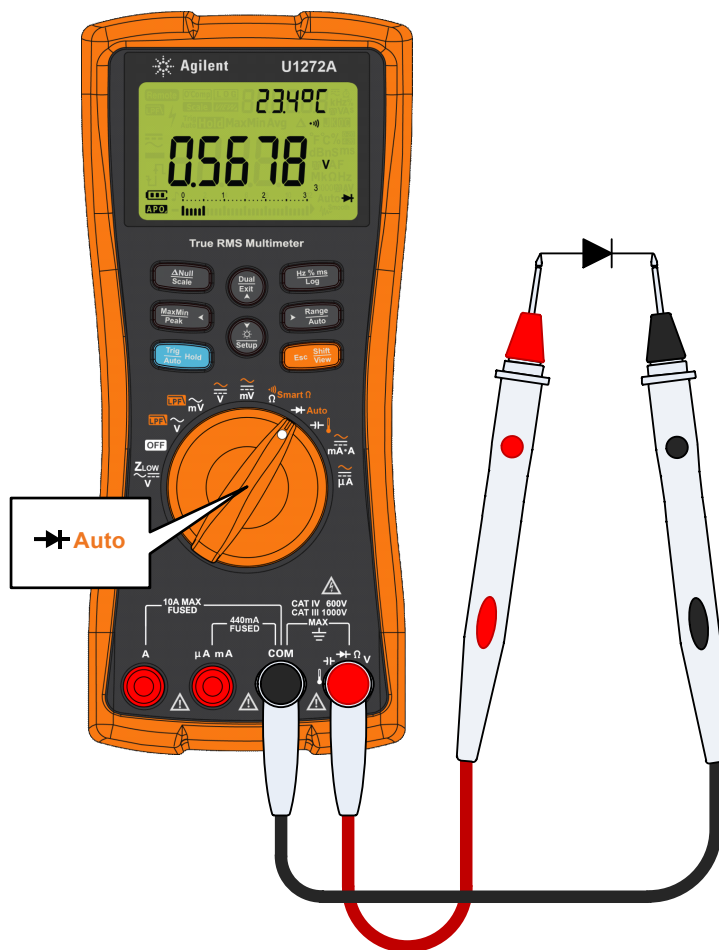
Figura 2-21 Testar o diodo de polarização direta
