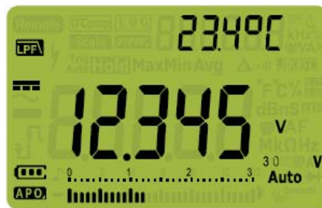
Figura 2-6 Filtro para medições de tensão CC
