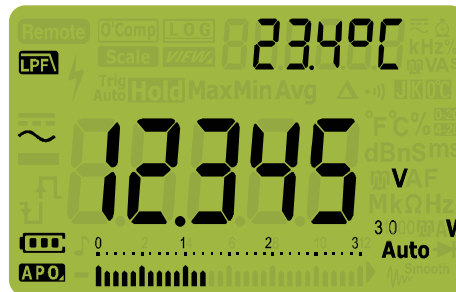
Figura 2-3 Tensão CA com a exibição do LPF
