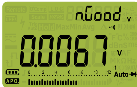
Figura 2-24 Exibição do diodo automático - Status: nGood (Não é bom)
