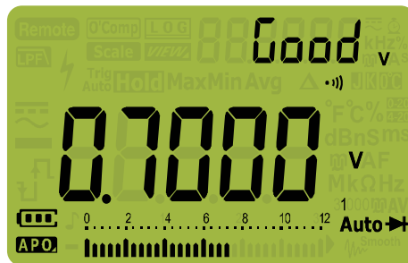
Figura 2-23 Exibição do diodo automático - Status: Good (Bom)
