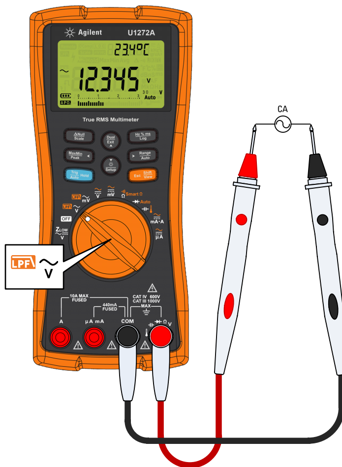
Figura 2-2 Medir a tensão CA
