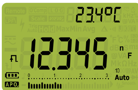
Figura 2-25 Exibição da capacitância
