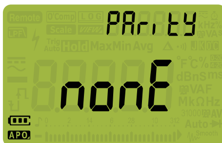
Figura 4-16 Exibição de PARitY
