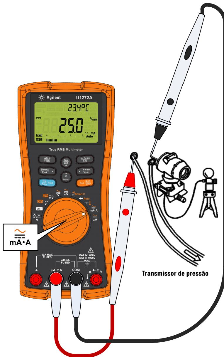
Figura 2-35 Medir a corrente CC usando a escala % 4–20 mA
