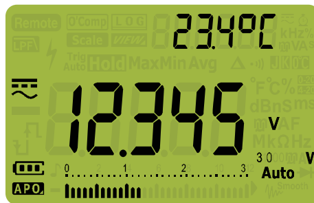
Figura 2-7 Exibição de tensão CA+CC
