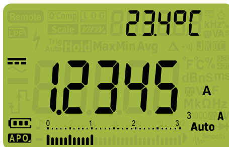
Figura 2-30 Exibição de corrente CC
