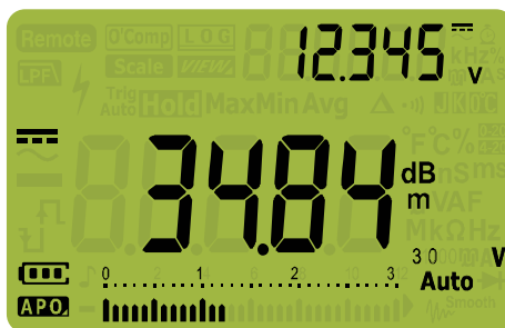
Figura 2-9 Exibição de dBm
