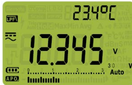
Figura 2-8 Filtro passa-baixo (LPF) para medições de tensões CA+CC
