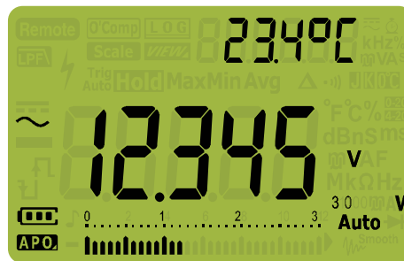
Figura 2-1 Exibição de tensão CA
