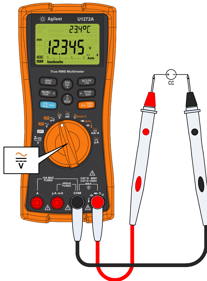
Figura 2-5 Medir a tensão CC
