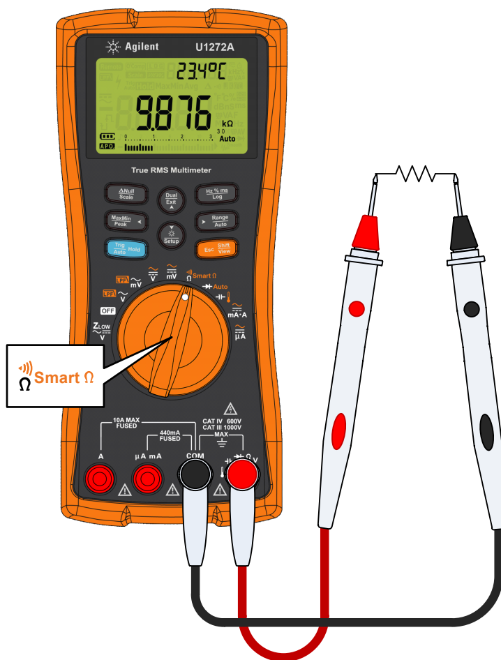
Figura 2-14 Medir a resistência
