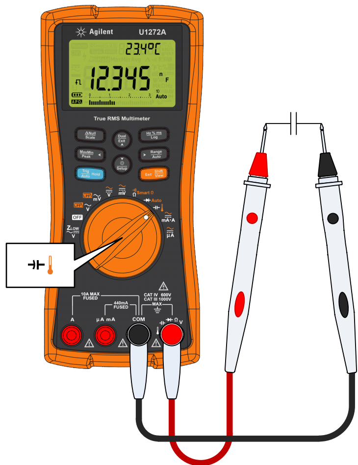
Figura 2-26 Medición de capacitancia
