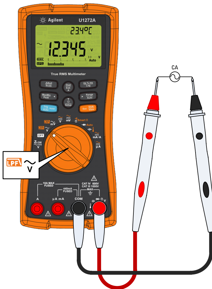
Figura 2-2 Medición de tensión de CA
