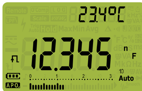
Figura 2-25 Visualización de capacitancia
