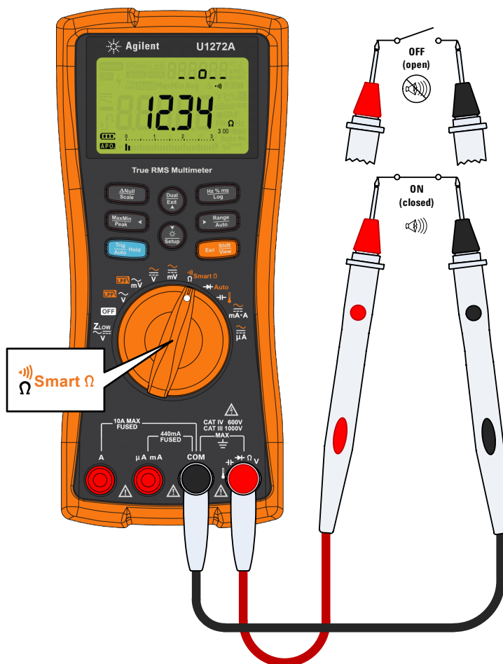
Figura 2-16 Cómo probar la continuidad
