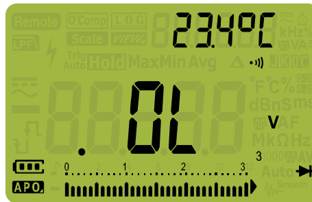
Figura 2-20 Visualización del diodo abierto
