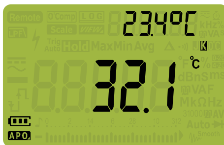
Figura 2-27 Visualización de temperatura
