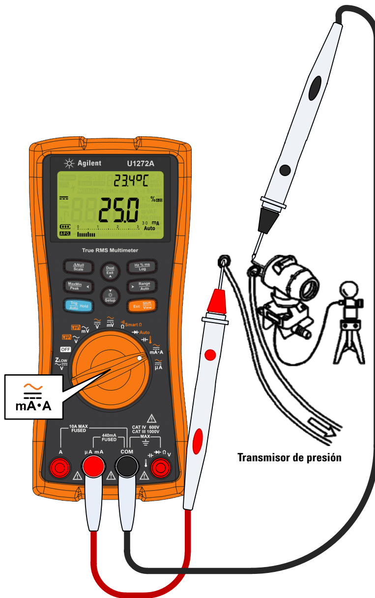
Figura 2-35 Medición de corriente cc utilizando la escala de % 4-20 mA
