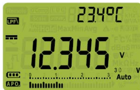
Figura 2-6 Filtro para mediciones de voltaje de CC
