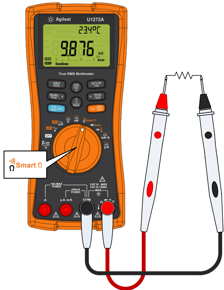
Figura 2-14 Medición de resistencia
