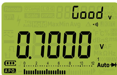
Figura 2-23 Visualización de autocomprobación de diodo - Estado: Good (Bien)
