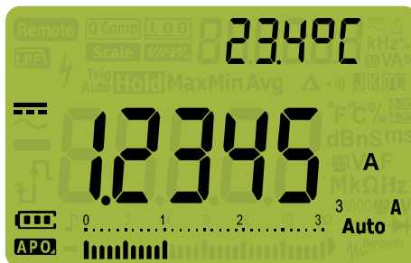
Figura 2-30 Visualización de corriente CC
