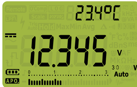
Figura 2-4 Visualización de tensión de CC
