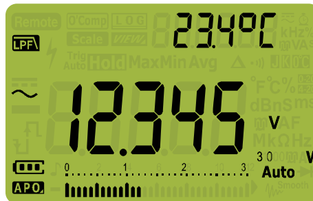
Figura 2-3 Tensión de CA con visualización de LPF
