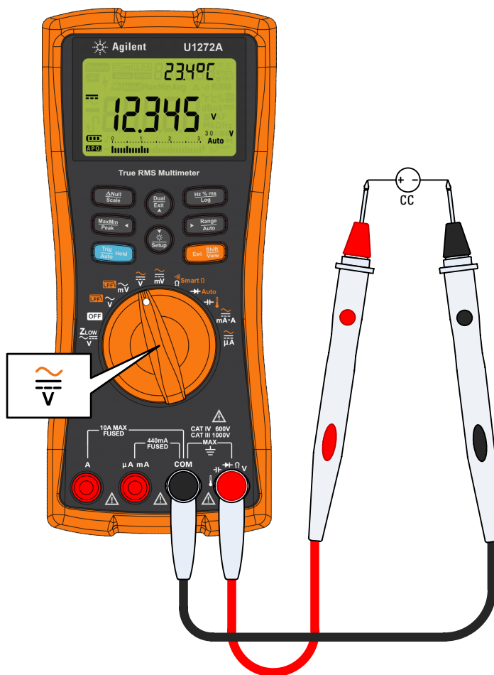
Figura 2-5 Medición de tensión de CC
