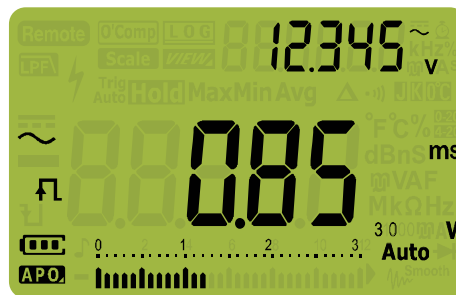
Figura 2-39 Visualización del ancho de pulso
