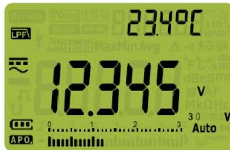
Figure 2-8 Filtre passe-bas (LPF) pour les mesures de tension CA+CC
