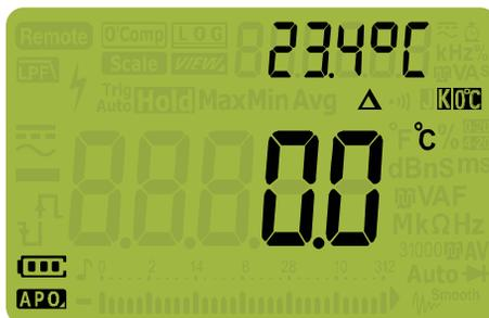
Figure 2-29 Mesure de température sans compensation ambiante
