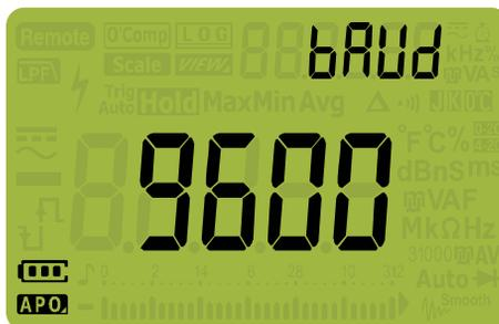
Figure 4-14 Affichage du paramètre bAUD
