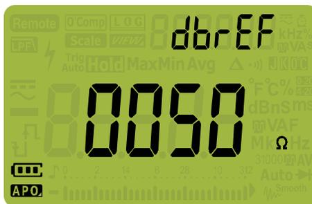
Figure 4-7 Affichage du paramètre dbrEF
