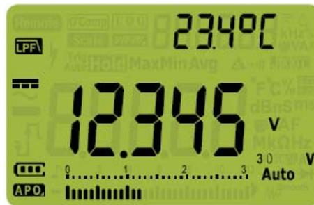
Figure 2-6 Filtre pour mesures de tension CC
