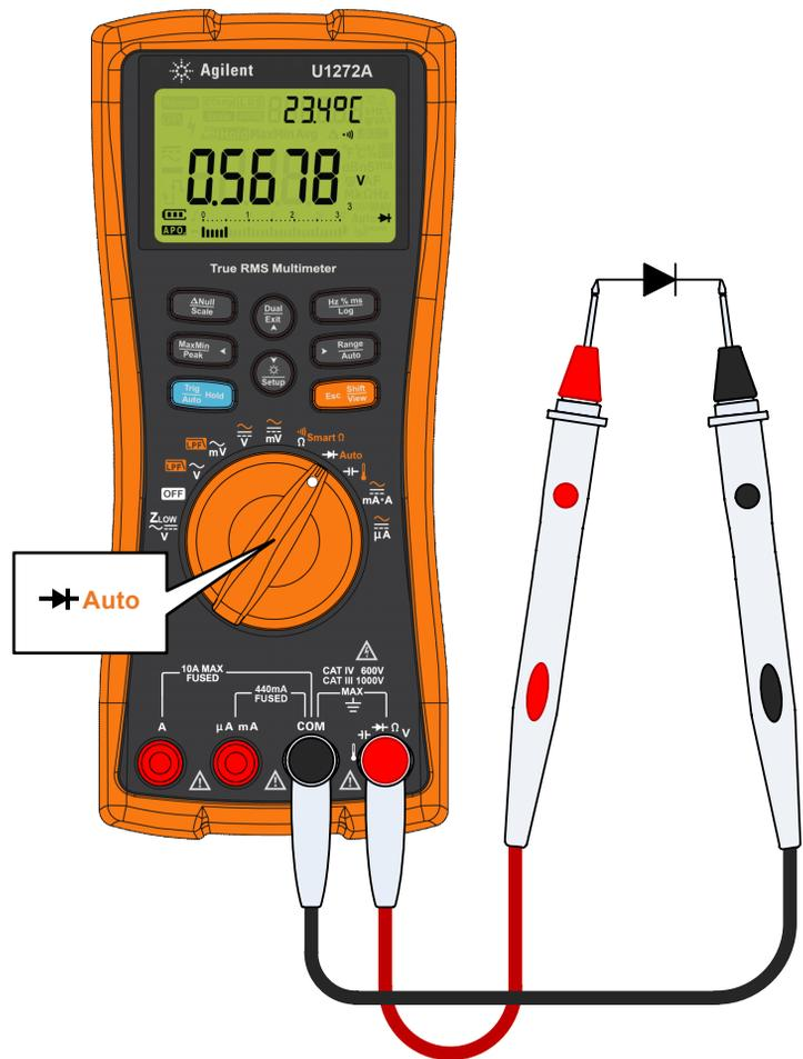
Figure 2-21 Test de polarisation directe de la diode
