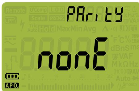
**Figure 4-16** Affichage du paramètre PARITY
