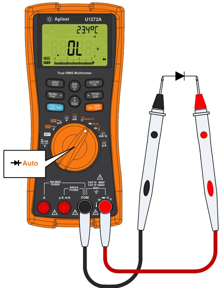
Figure 2-22 Test de polarisation inverse de la diode
