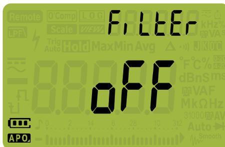
Figure 4-2 Affichage du paramètre FilTEr
