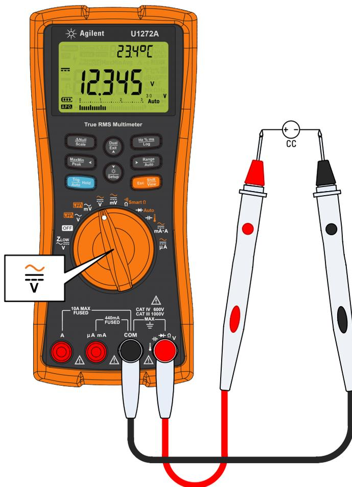
Figure 2-5 Mesure d'une tension CC
