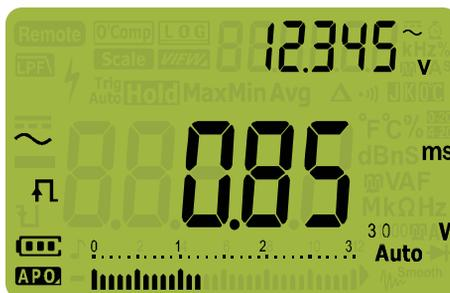
Figure 2-39 Affichage de la largeur d'impulsion
