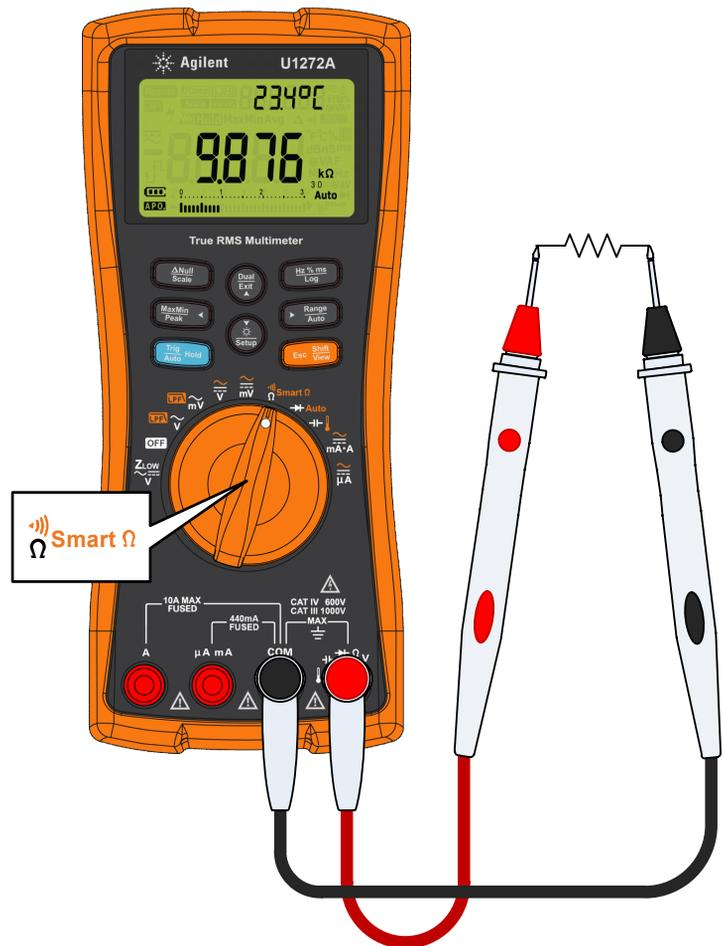
Figure 2-14 Mesure de la résistance
