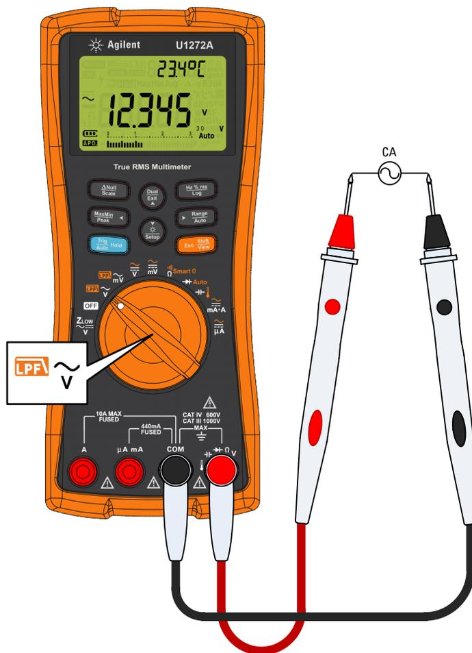
Figure 2-2 Mesure de tension CA
