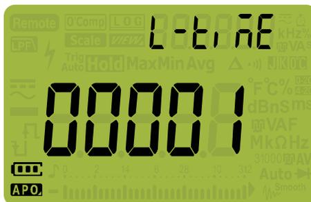
Figure 4-5 Affichage du paramètre L-tiME
