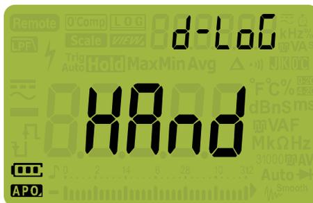
**Figure 4-4** Affichage du paramètre d-LoG
