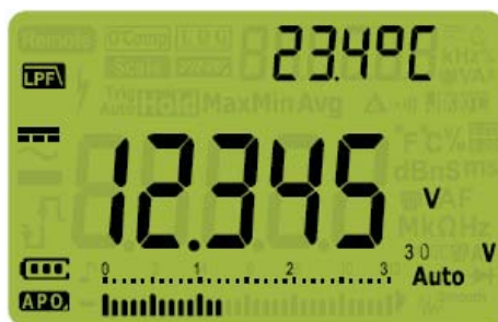
Figura 2-6 Filtro per le misurazioni di tensioni CC
