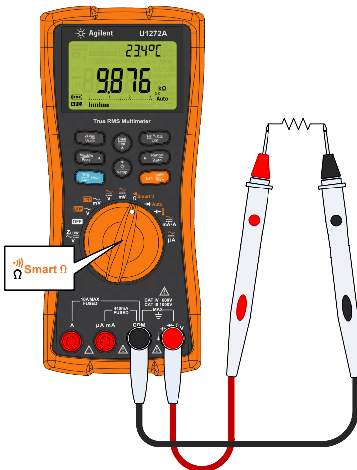
Figura 2-14 Misurazione della resistenza
