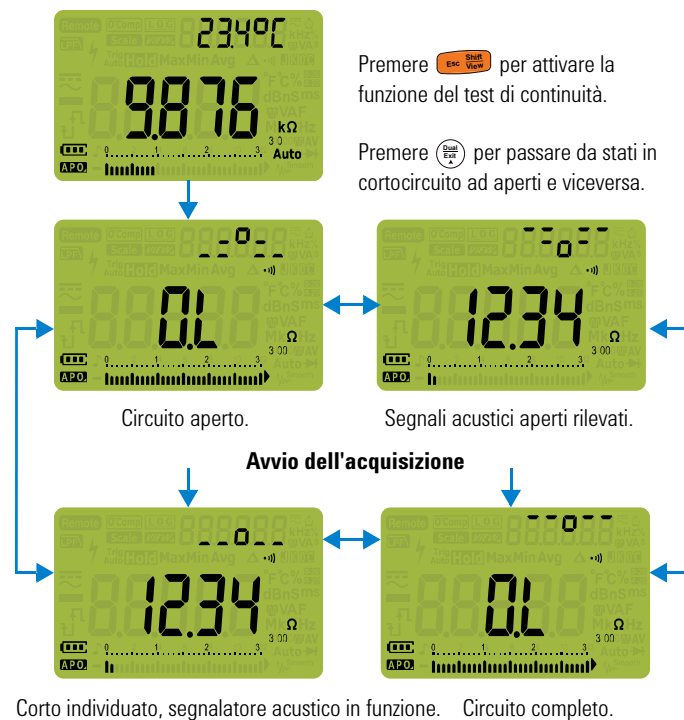
Figura 2-15 Operazione di continuità
