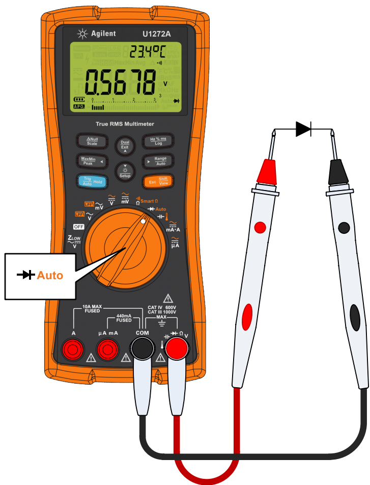
Figura 2-21 Test di diodi con polarizzazione diretta
