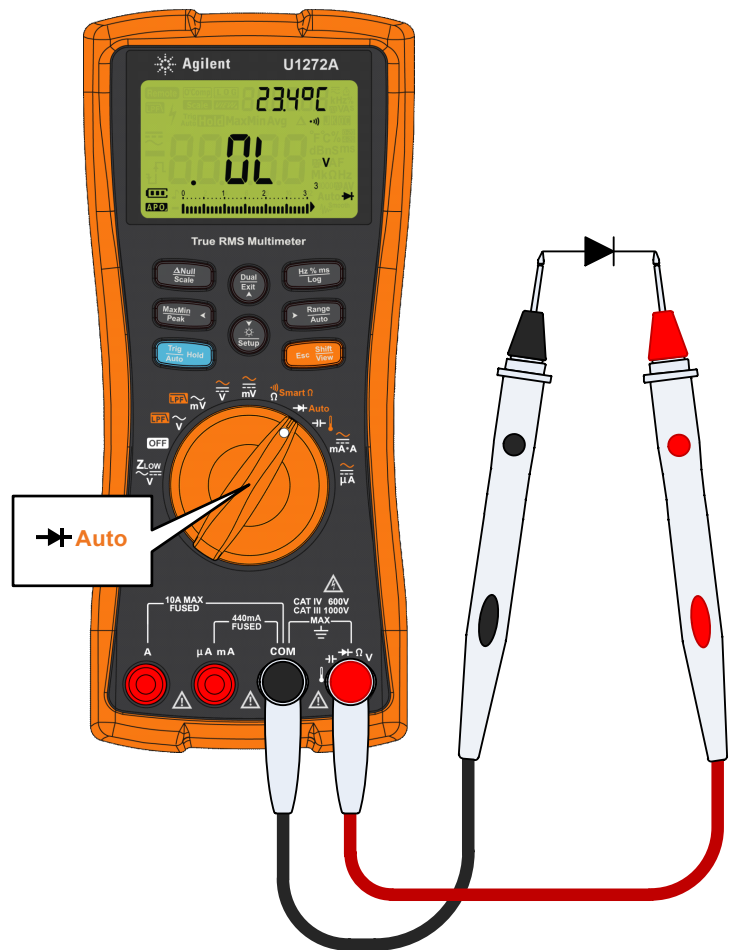
Figura 2-22 Test di diodi con polarizzazione inversa
