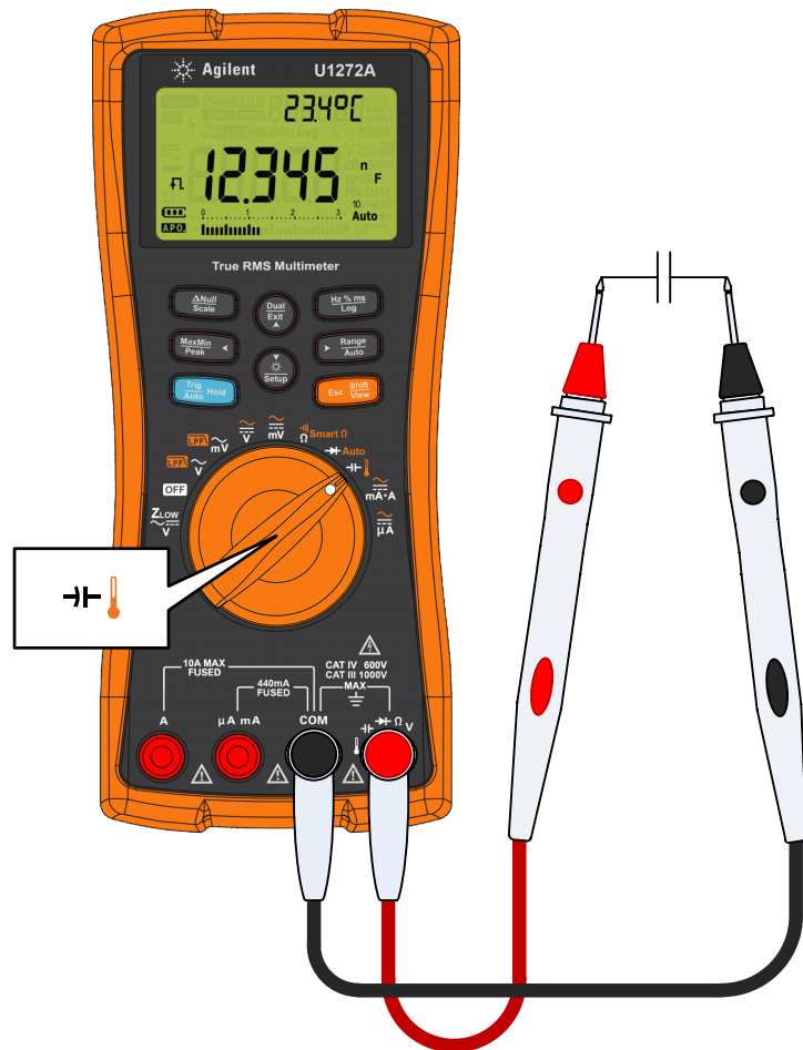
Abbildung 2-26 Messen der Kapazität
