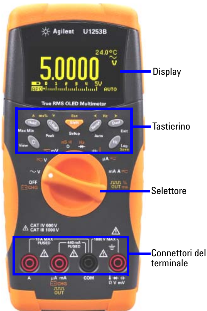
Figura 1-4 Pannello anteriore del modello U1253B
