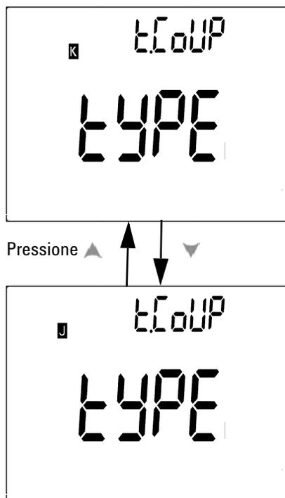
Figura 4-3 Configuração do tipo de termopar
