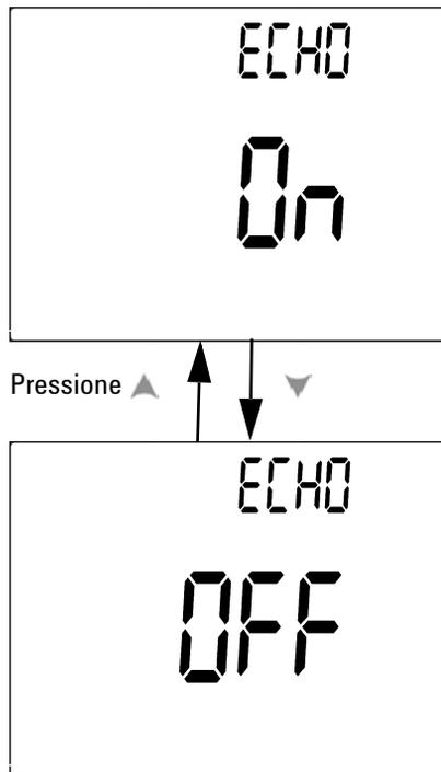
**Figura 4-14** Configuração do modo de Eco para controle remoto
