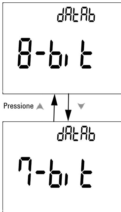
**Figura 4-13** Configuração do bit de dados para controle remoto
