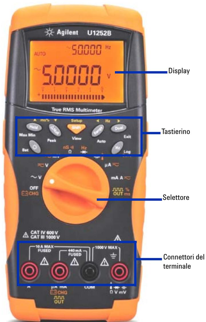
Figura 1-4 Pannello anteriore del modello U1252B
