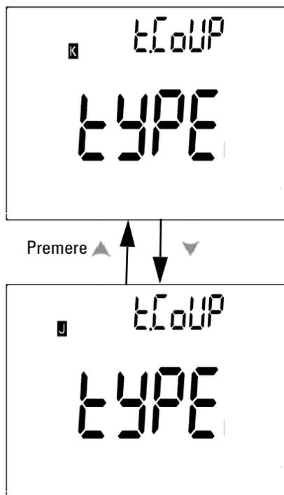
**Figura 4-3** Impostazione del tipo di termocoppia
