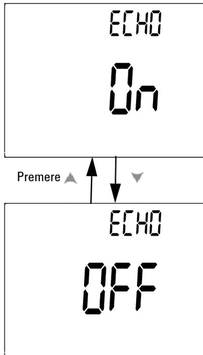
**Figura 4-14** Impostazione della modalità Echo per il controllo remoto
