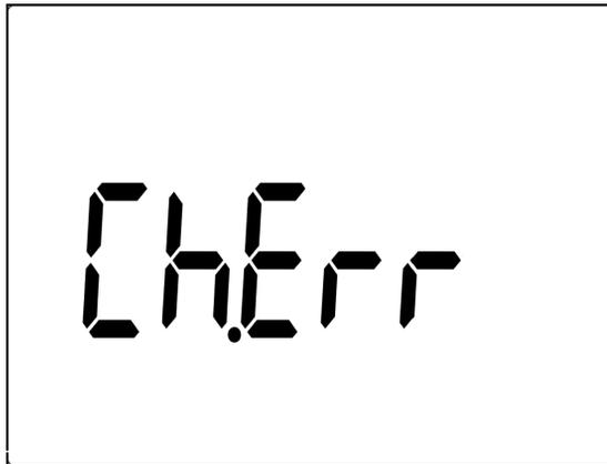
**Figura 2-17** Avviso per terminale di carica
