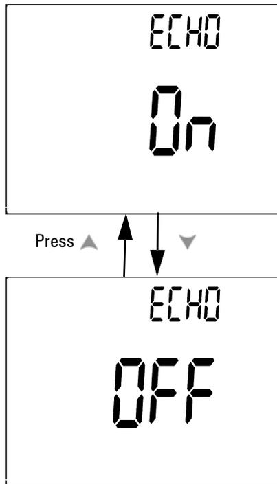
**Abbildung 4-14** Einrichtung des Echomodus für die Fernsteuerung
