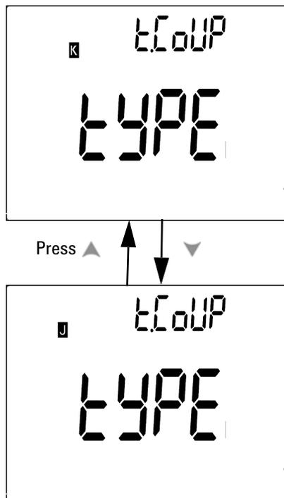
Abbildung 4-3 Einrichtung des Thermoelementtyps
