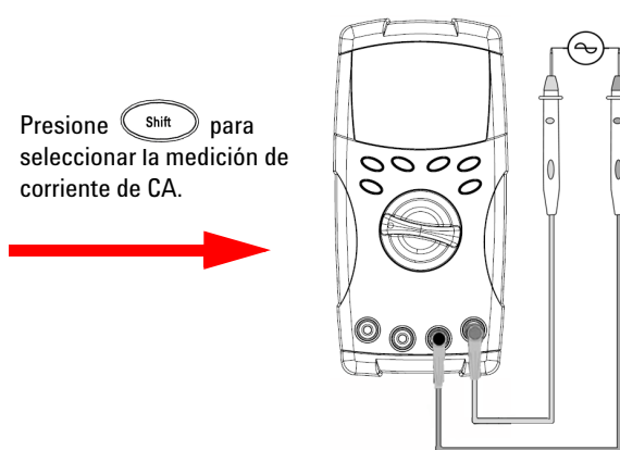
Medición de Voltaje CA
