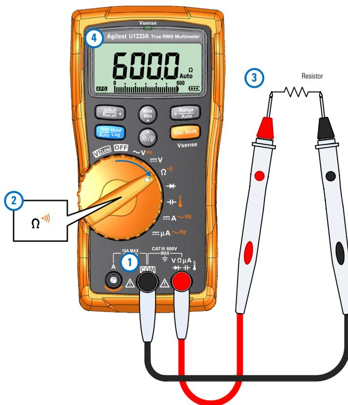
Figura 2-9 Medición de resistencia
