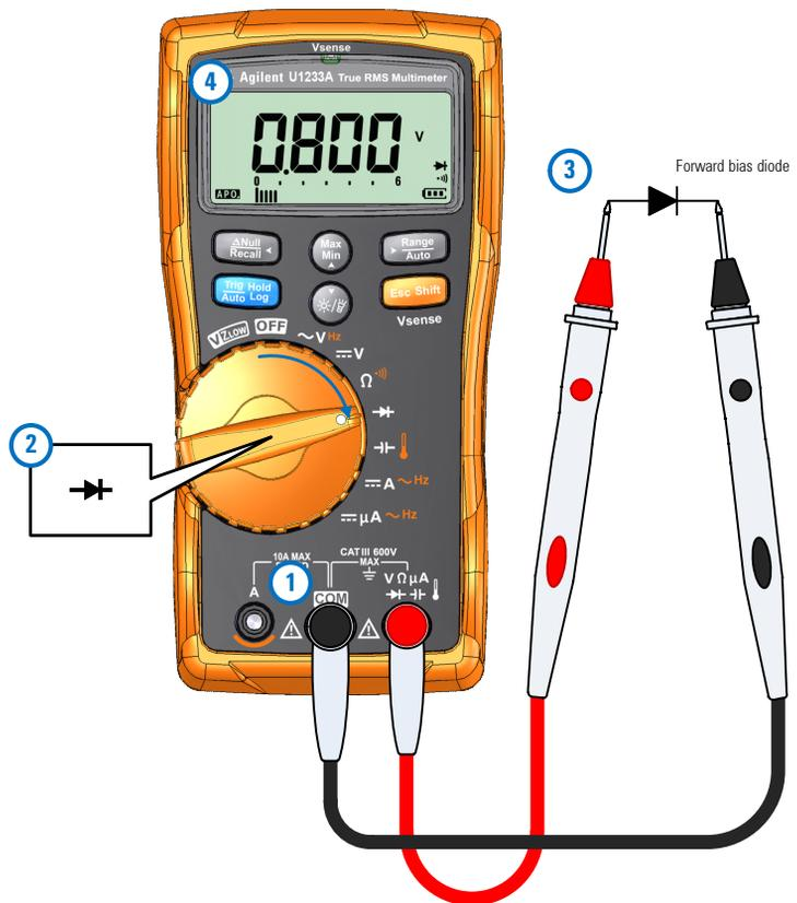
Figura 2-14 Prueba de diodo de polarización directa
