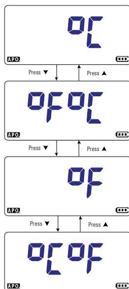
Figura 4-17 Modificación de la unidad de temperatura
