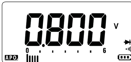
Figura 2-12 Visualización de diodo
