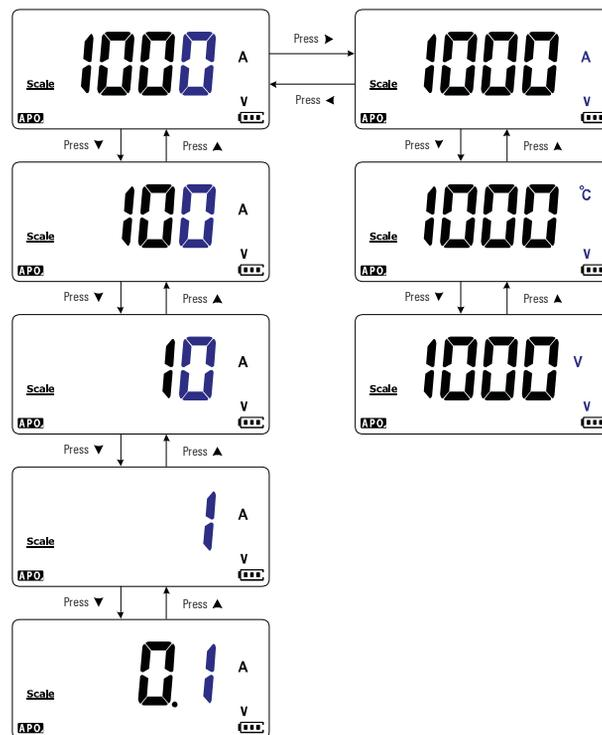
**Figura 4-14** Modificación del valor de conversión de escala
