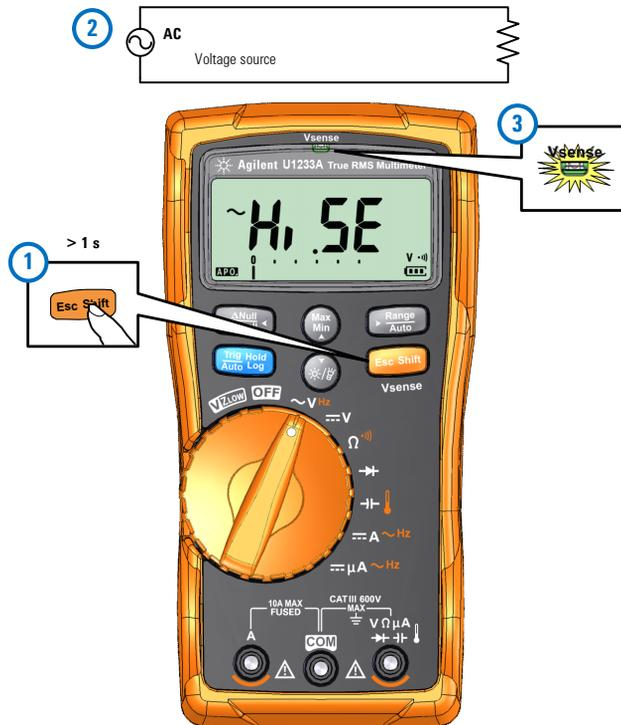
**Figura 3-1** Detección de presencia de tensión
