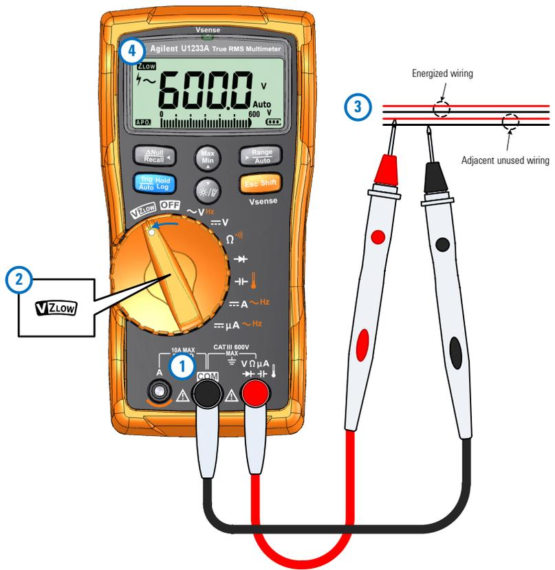
Figura 2-6 Medición de tensión  $V_{Z_{LOW}}$
