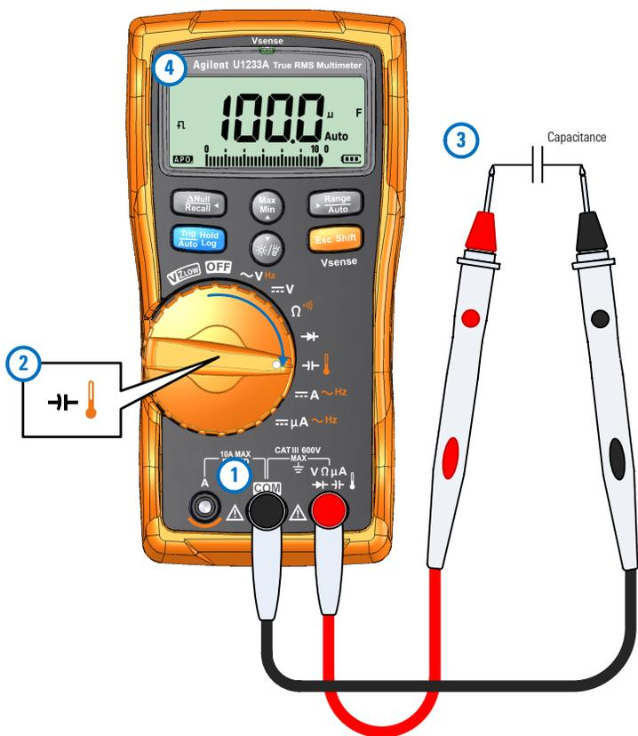
**Figura 2-17** Medición de capacitancia
