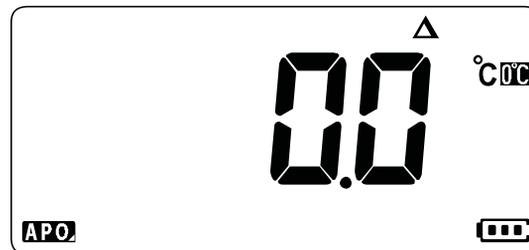
Figura 2-21 Medición de temperatura sin compensación ambiental
