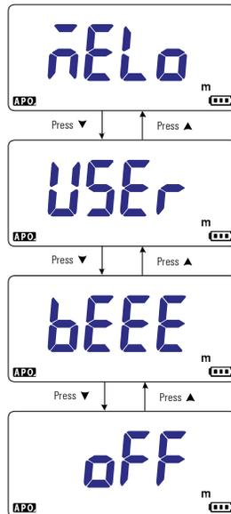
**Figura 4-12** Modificación del tono del saludo de encendido
