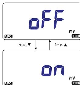
**Figura 4-15** Active la medición de CA/CC mV
