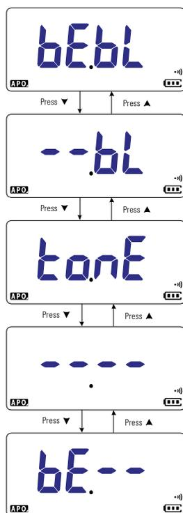
Figura 4-11 Modificación de las alertas de pruebas de continuidad
