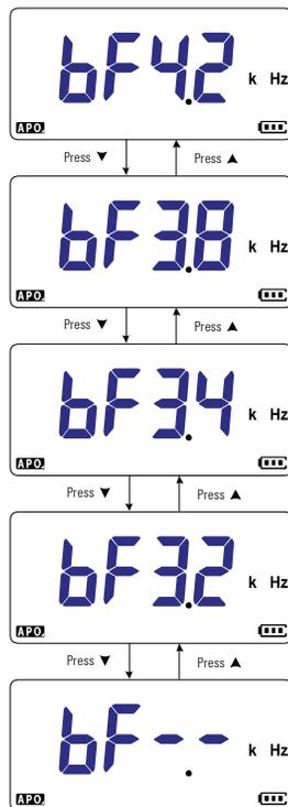
Figura 4-4 Cambio de la frecuencia del sonido
