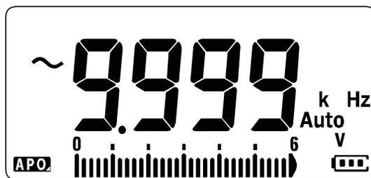
Figura 2-27 Visualización de frecuencia
