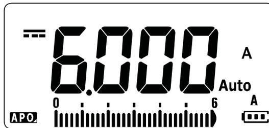
Figura 2-22 Visualización de corriente de CC
