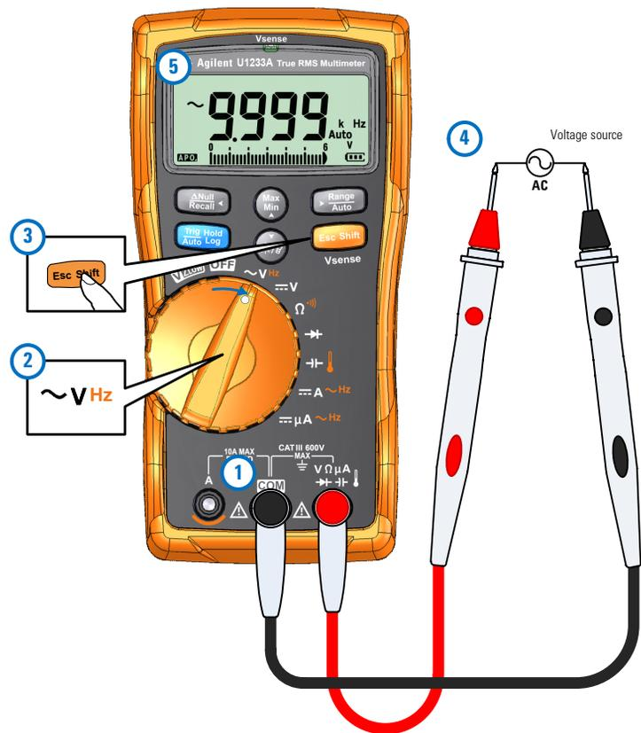
**Figura 2-28** Medición de frecuencia
