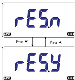
Figura 4-13 Restablecimiento de los elementos de configuración
