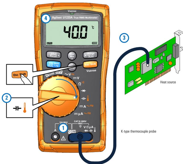
**Figura 2-19** Medición de temperatura de la superficie
