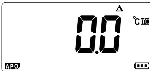
Figura 2-21 Misurazione della temperatura senza compensazione ambiente
