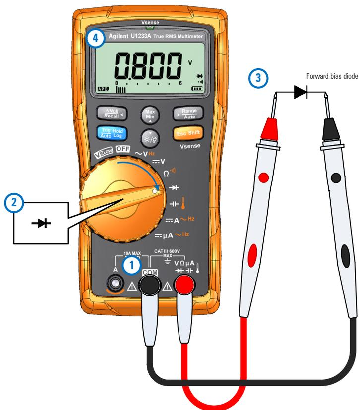
Figura 2-14 Test di diodi con polarizzazione diretta
