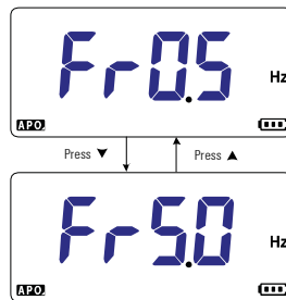
Abbildung 4-10 Ändern der minimal messbaren Frequenz
