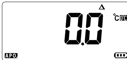
Abbildung 2-21 Temperaturmessungen ohne Umgebungskompensation
