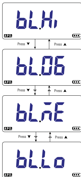
Abbildung 4-7 Ändern der Intensität der LCD-Hintergrundbeleuchtung
