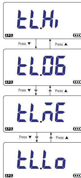
Abbildung 4-9 Ändern der Intensität des LED-Blinklichts
