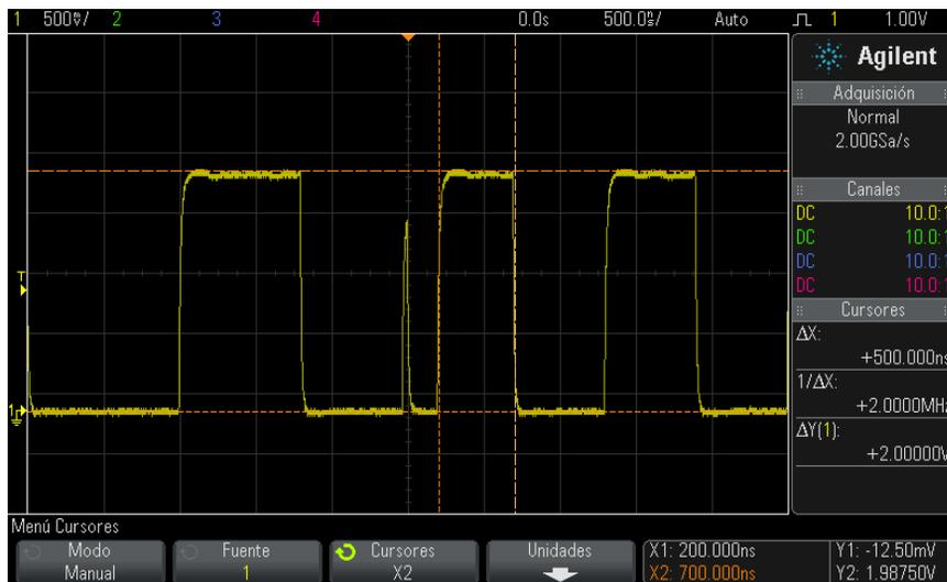
**Imagen 31** Medición de ancho de pulso con cursores
