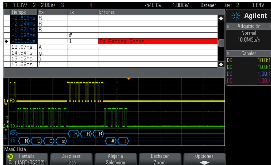
Antes de seleccionar una fila o navegar por los datos de la Lista, deben detenerse las adquisiciones del osciloscopio.
