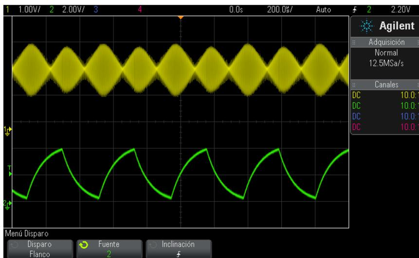
**Imagen 14** Modulación de amplitud representada con intensidad del 40%
