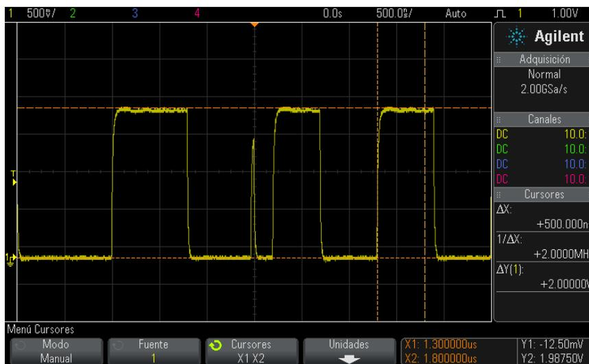
**Imagen 32** Unión de los cursores para controlar variaciones de ancho de pulso
