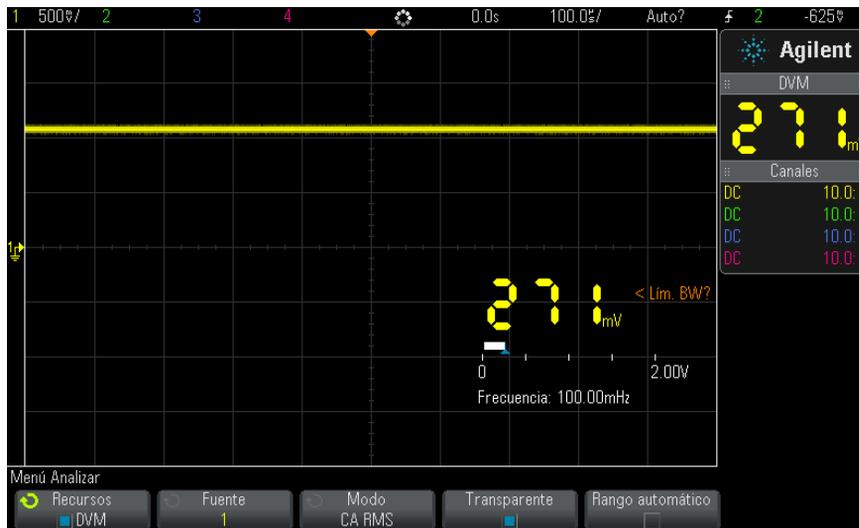
El DVM realiza mediciones precisas de RMS cuando la frecuencia de la señal está entre 20 Hz y 100 kHz. Cuando la frecuencia de la señal está fuera de este rango, aparece "<Lím. BW?" o ">Lím. BW?" en la pantalla del DVM para advertir sobre los resultados inexactos de la medición de RMS.
