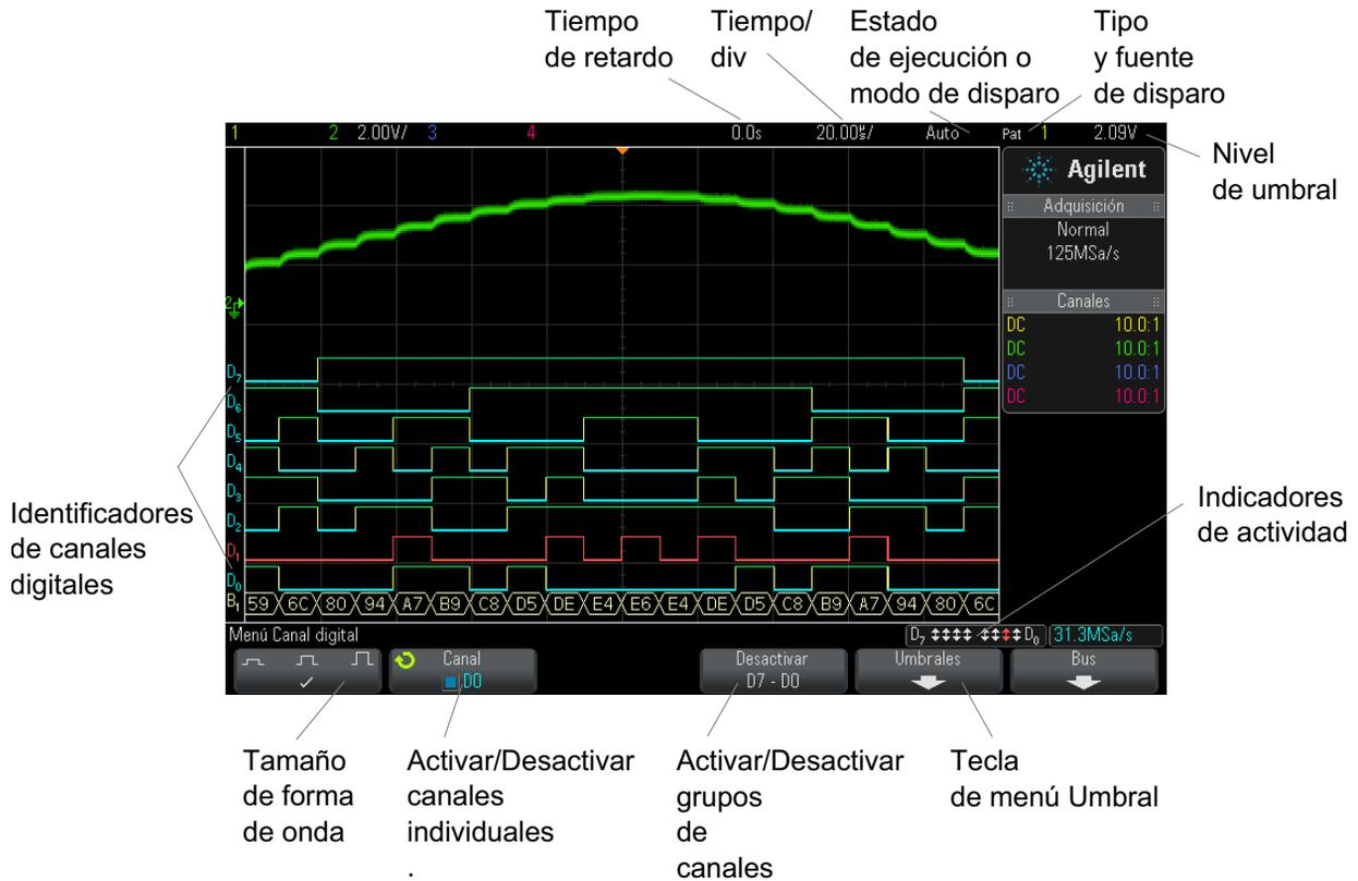
**Indicador de actividad** Cuando hay algún canal digital activo, se muestra un indicador de actividad en la línea de estado, en la parte inferior de la pantalla. Los canales digitales pueden estar siempre altos (■), siempre bajos (■) u oscilando activamente entre estados lógicos (↕). Los canales inactivos aparecen en gris en el indicador de actividad.
