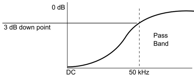
El rechazo de baja frecuencia elimina cualquier componente no deseado de baja frecuencia de la forma de onda del disparo, tal como frecuencias de línea de alimentación, etc., que pueda interferir con un buen disparo.
