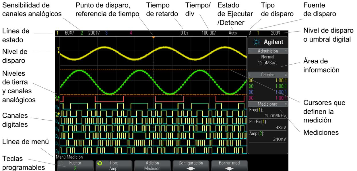
**Imagen 1** Interpretación de la pantalla del osciloscopio
