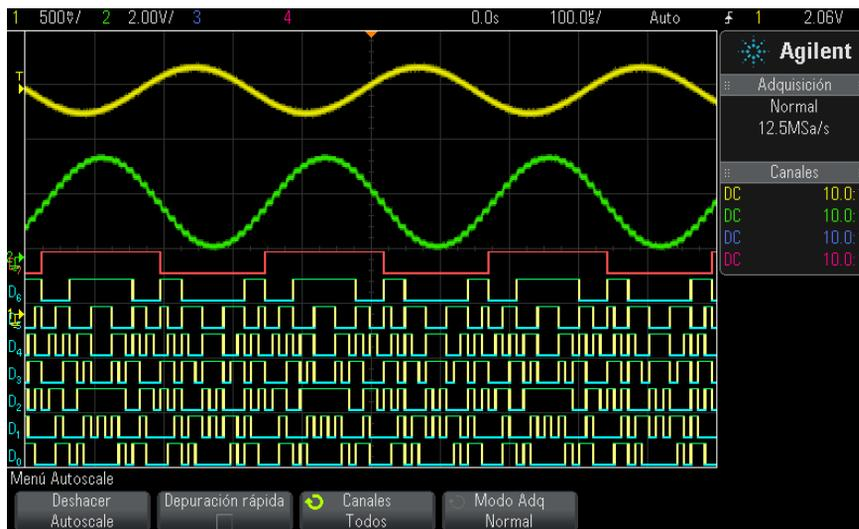
**Imagen 8** Ejemplo: Escala automática de canales digitales (sólo en modelos MSO)
