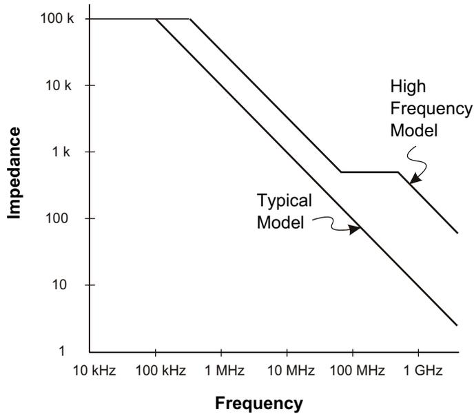
**Imagen 11** Impedancia versus frecuencia para ambos modelos de circuitos de sondas
