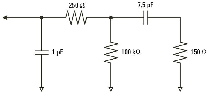
**Imagen 10** Circuito equivalente de sonda de alta frecuencia
