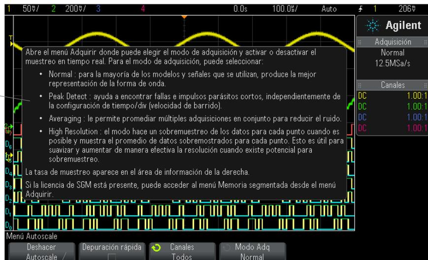
Mantenga presionada la tecla programable o la tecla del panel frontal (o haga clic con el botón derecho sobre la tecla programable al usar el panel frontal remoto del navegador web).
