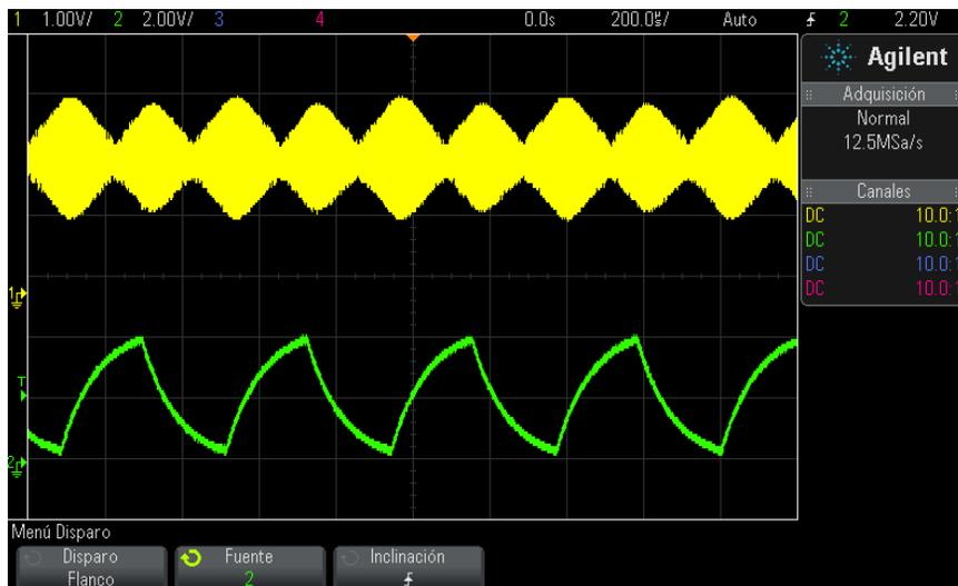
**Imagen 13** Modulación de amplitud representada con intensidad del 100%
