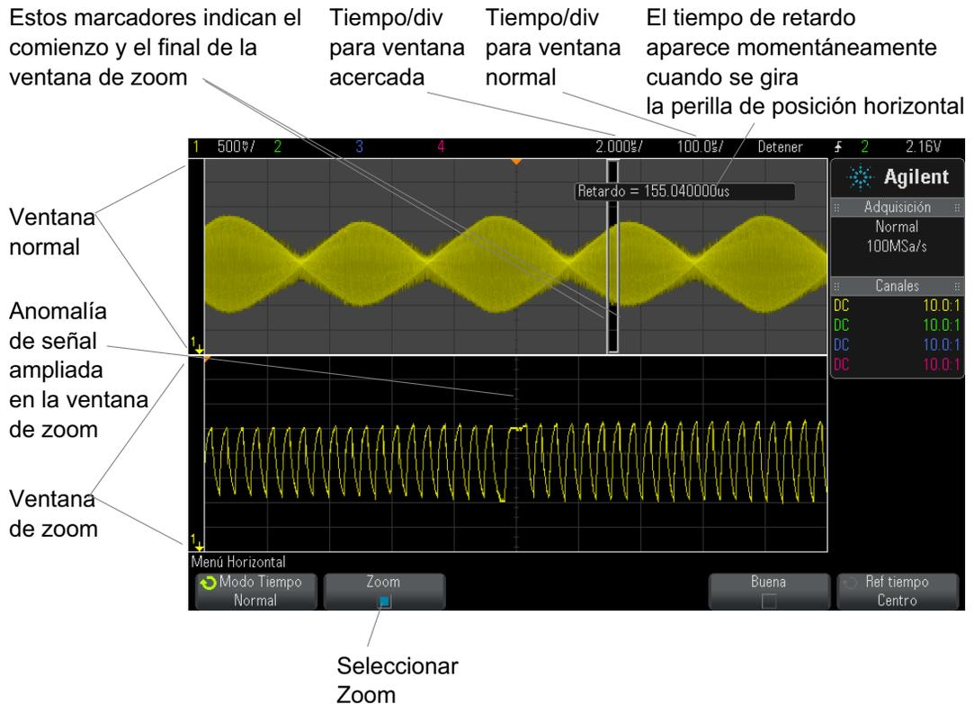
El área de la pantalla normal ampliado se marca con un recuadro y el resto de la pantalla normal aparece atenuado. El recuadro muestra qué parte del barrido normal se encuentra ampliada en la mitad inferior.
