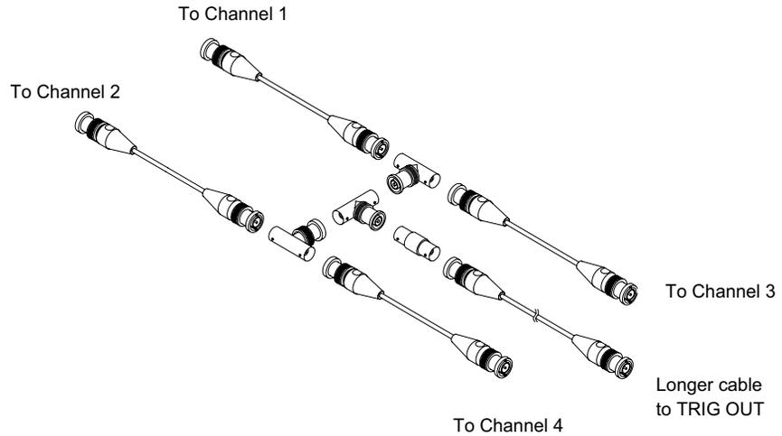
**Imagen 37** Cable de calibración del usuario para osciloscopio de 4 canales
