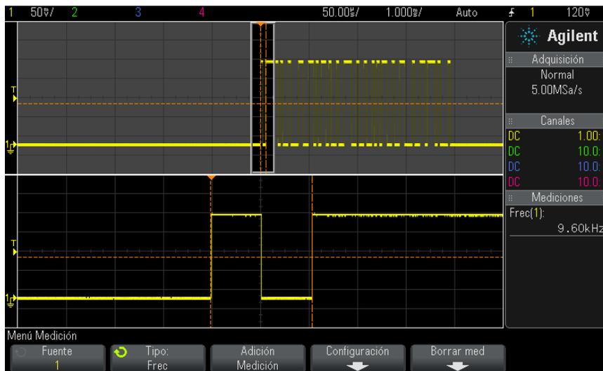
**Imagen 35** Aislamiento de un evento para la medición Frecuencia
