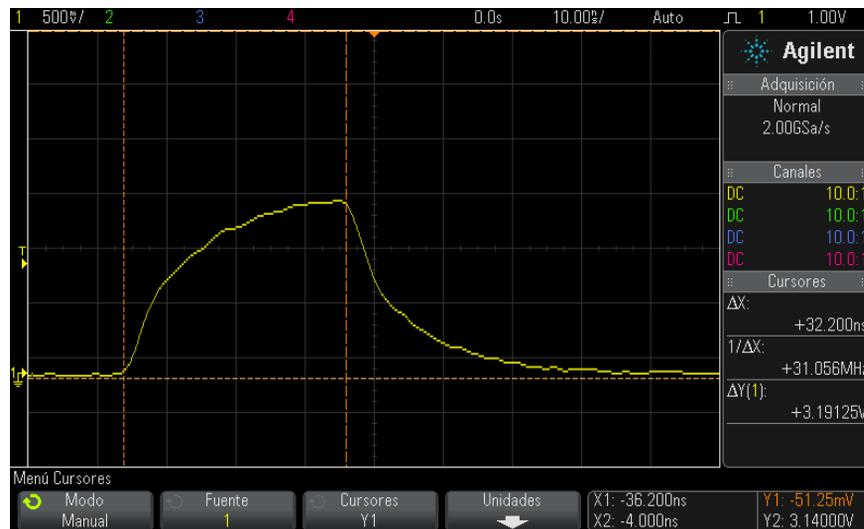
**Imagen 28** Cursores usados para medir anchos de pulso que no sean puntos de umbral medio
