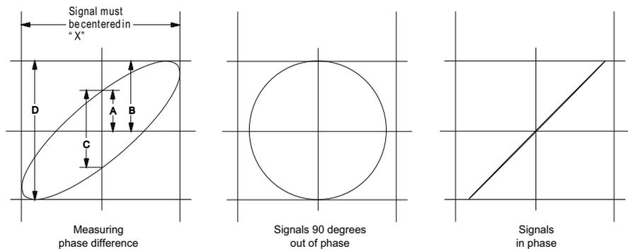
**Imagen 3** Señales de modo de tiempo XY, centradas en la pantalla
