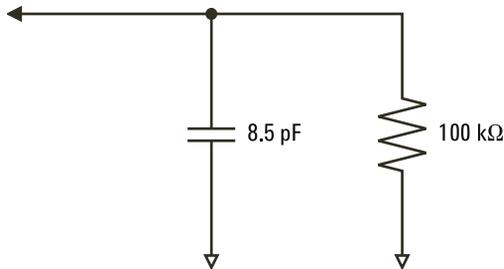
**Imagen 9** Circuito equivalente de sonda de CC y baja frecuencia
