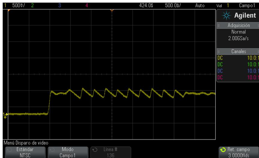
**Imagen 20** Uso de Ret. campo para sincronizar con campo color 1 o 3 (modo Campo 1)
