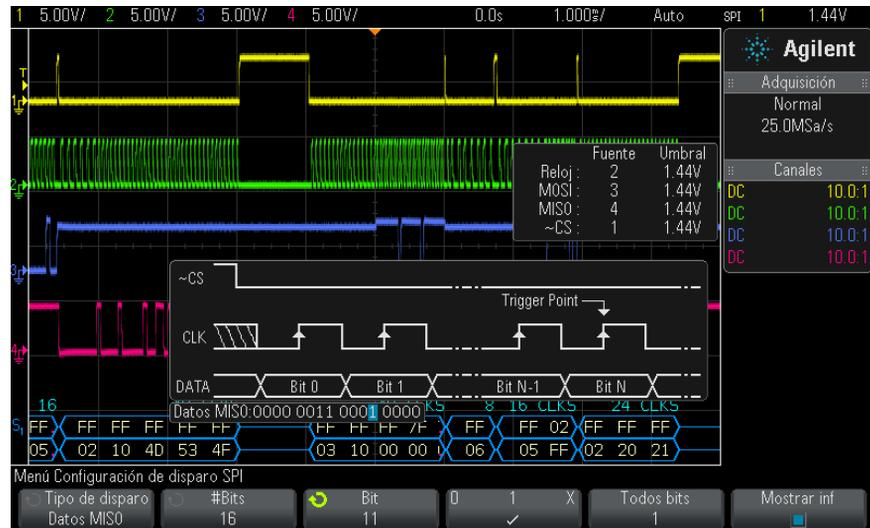
La tecla programable **Todos bits** configura todos los bits de la cadena de datos con el valor de la tecla programable **0 1 X**.
