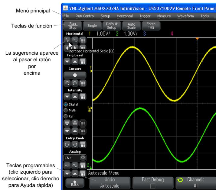
**Desplazamiento y resolución del monitor**
