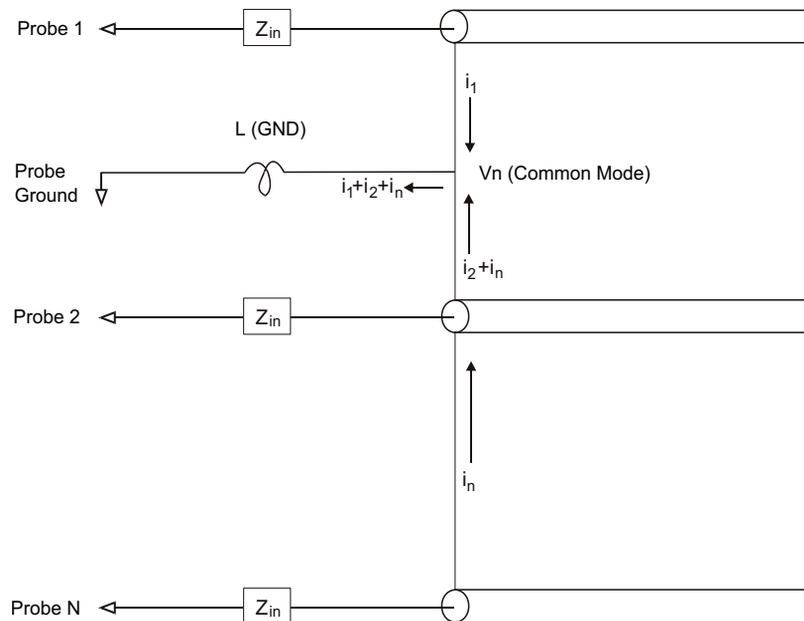
**Imagen 12** Modelo de voltaje de entrada de modo común
