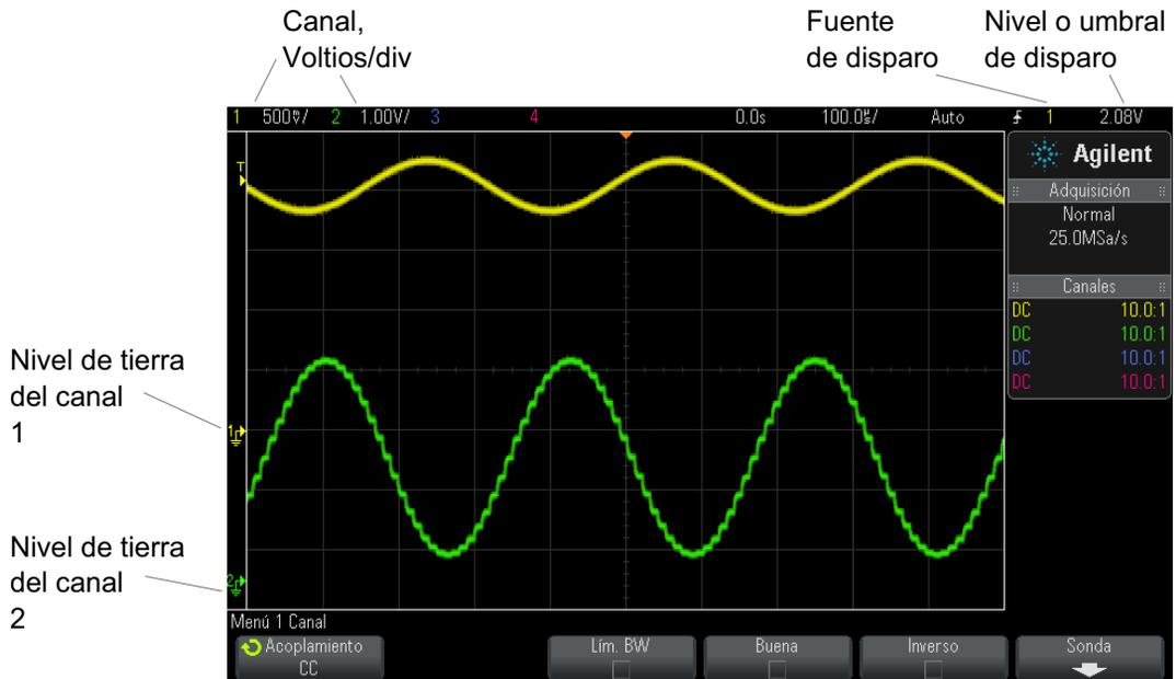
El nivel de tierra de la señal para cada canal analógico representado se identifica por la posición del ícono  $\oplus$  en el extremo izquierdo de la pantalla.
