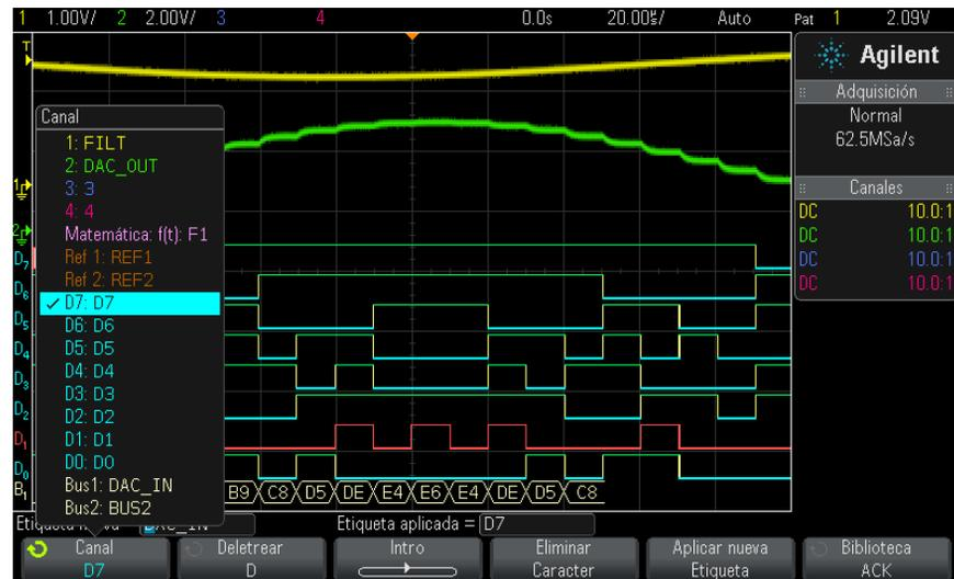
En la figura anterior se ve la lista de canales y sus etiquetas predeterminadas. El canal no necesita estar activado para tener una etiqueta asignada.
