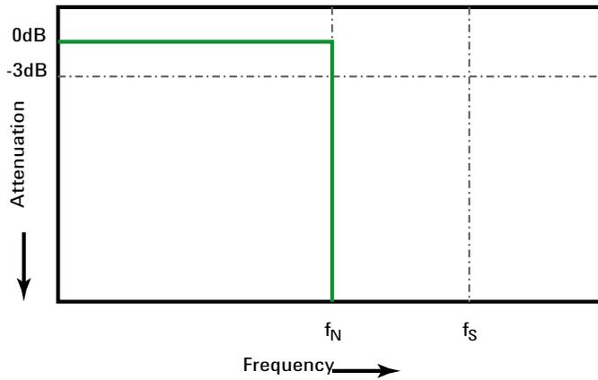
**Imagen 22** Respuesta de frecuencia de pared de ladrillos teórica
