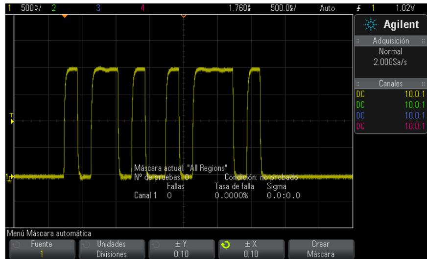
7 Ajuste la tolerancia horizontal ( $\pm Y$ ) y vertical ( $\pm X$ ) de la máscara. Se pueden ajustar en divisiones de retícula o en unidades absolutas (voltios o segundos); esto se selecciona mediante la tecla programable **Unidades**.
