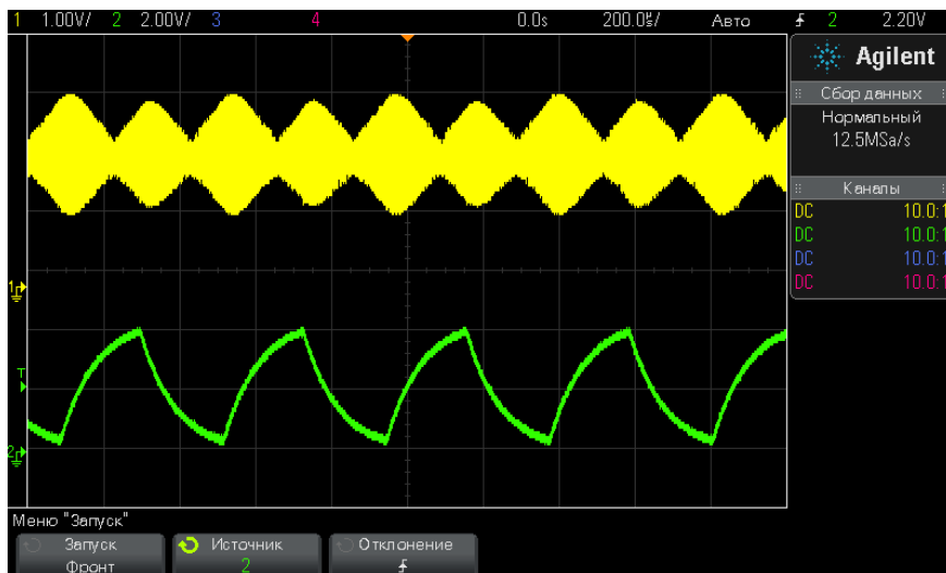
Рис. 13 Отображение амплитудной модуляции при яркости 100%
