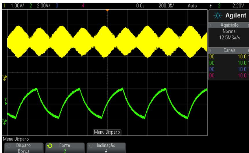
**Figura 13** Modulação de amplitude mostrada em intensidade de 100%
