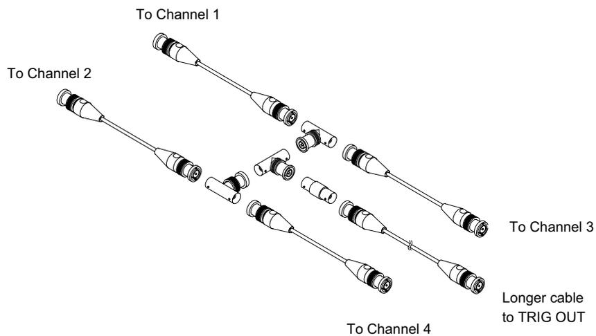
**Figura 37** Cabo de calibração feita pelo usuário para osciloscópio de quatro canais
