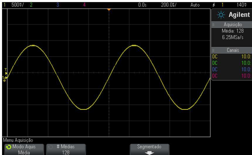
**Figura 27** 128 Médias usadas para reduzir o ruído aleatório
