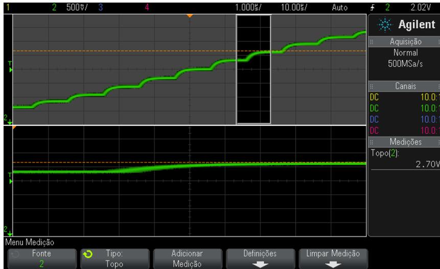
Figura 33 Isolar área para medição de topo
