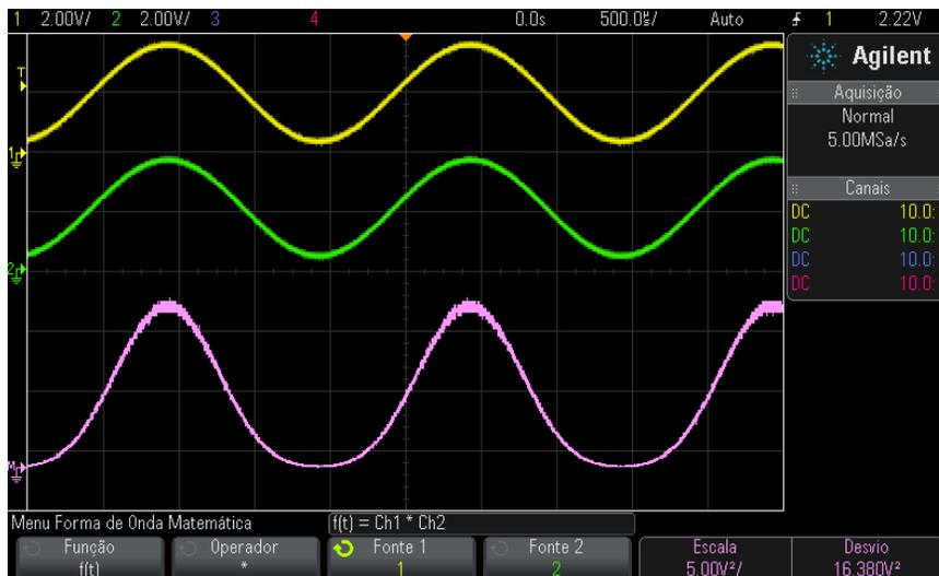
**Figura 6** Exemplo de multiplicação do canal 1 pelo canal 2.
