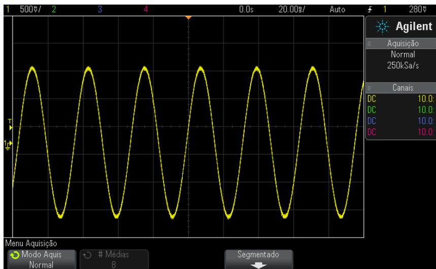
**Figura 24** Senoidal com glitch, modo normal
