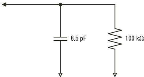
**Figura 9** Circuito equivalente à ponta de prova de CC e baixa frequência
