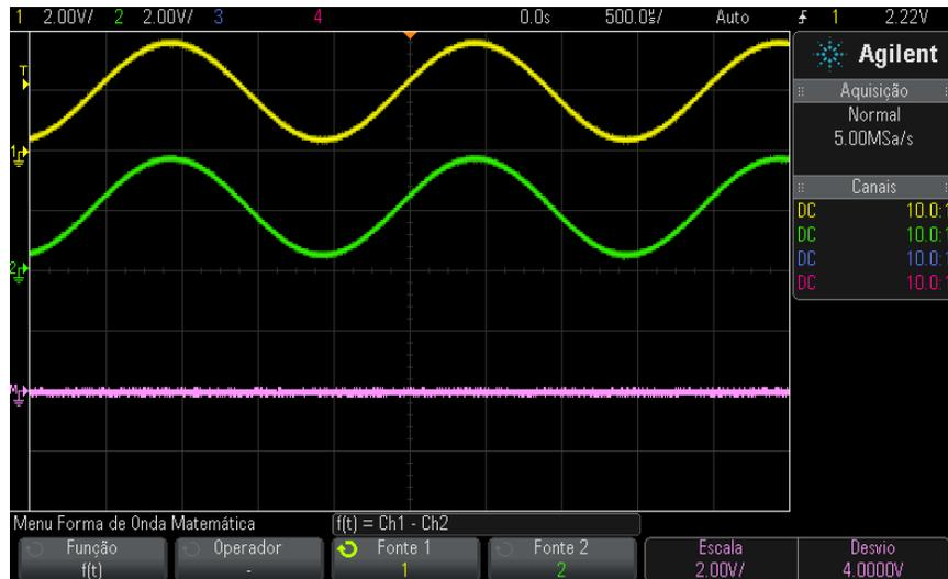
**Figura 5** Exemplo de subtração do canal 2 do canal 1
