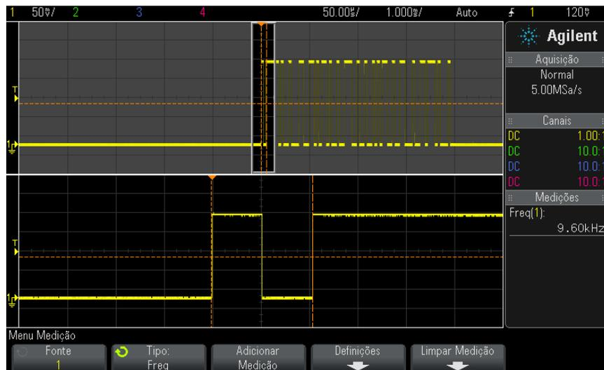
**Figura 35** Isolar um evento para medição de frequência
