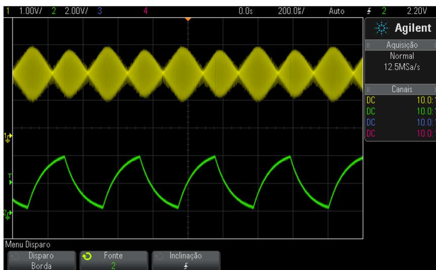
**Figura 14** Modulação de amplitude mostrada em intensidade de 40%
