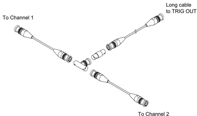
**Figura 36** Cabo de calibração feita pelo usuário para osciloscópio de dois canais
