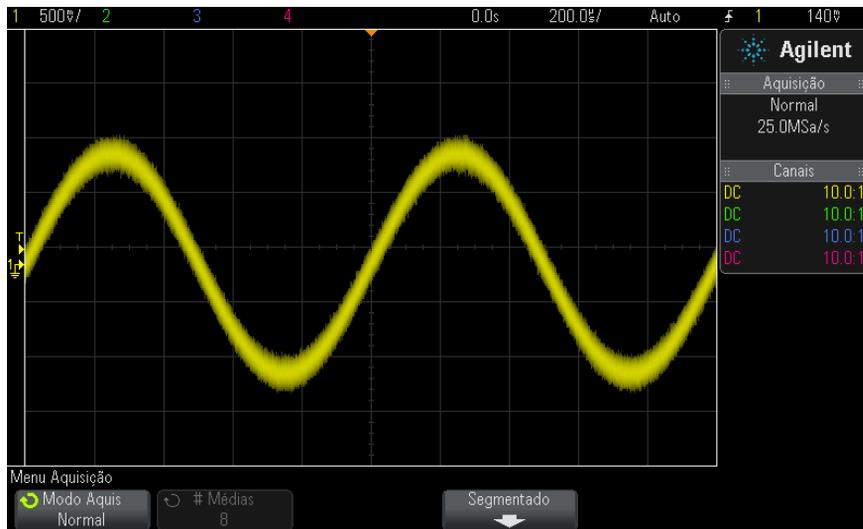
**Figura 26** Ruído aleatório na forma de onda exibida
