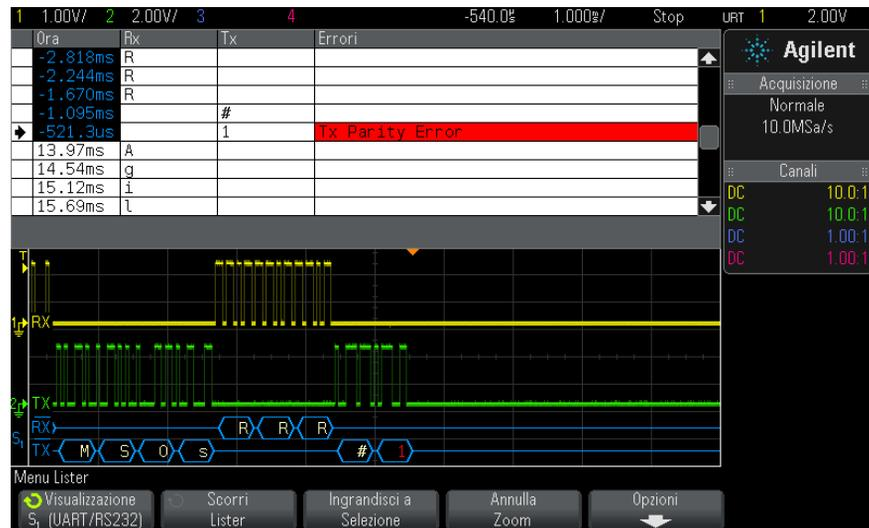
Prima di poter selezionare una riga o navigare tra i dati Lister, è necessario arrestare le acquisizioni dell'oscilloscopio.
