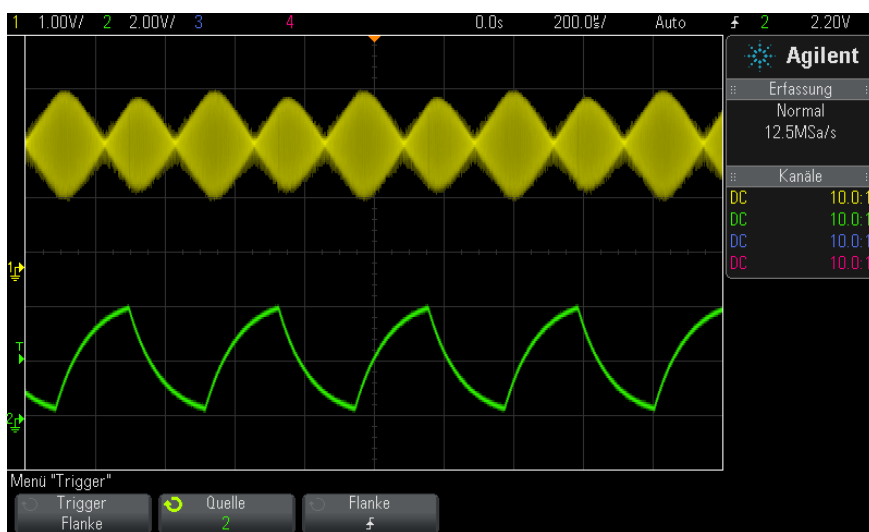
Abbildung 14 Amplitudenmodulation bei 40% Intensität
