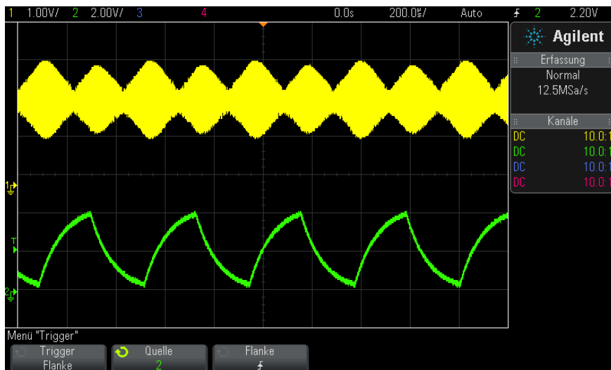
Abbildung 13 Amplitudenmodulation bei 100% Intensität
