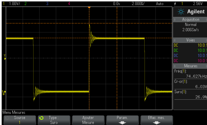
Figure 34 Mesure automatique de la suroscillation
