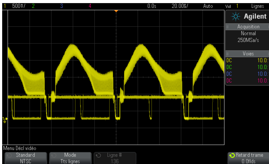
Figure 16 Déclenchement sur toutes les lignes
