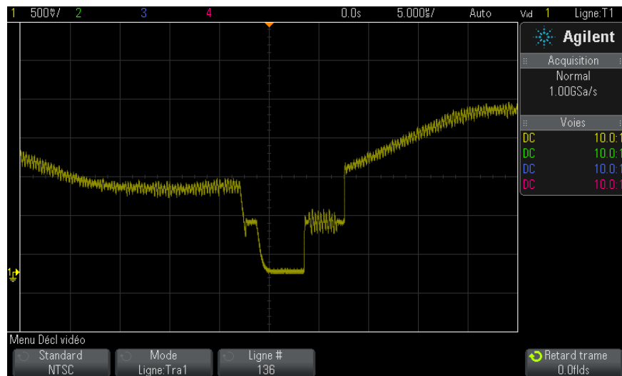
Figure 15 Exemple : déclenchement sur la ligne 136
