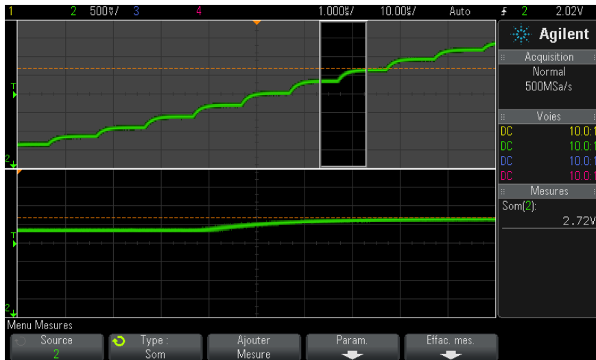
Figure 33 Isolation d'une zone à des fins de mesure du sommet
