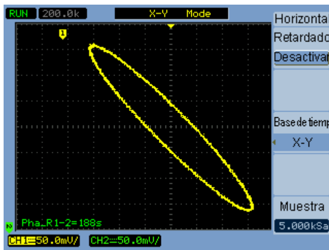
Imagen 15 Formato de imagen X-Y con formas de onda fuera de frecuencia
