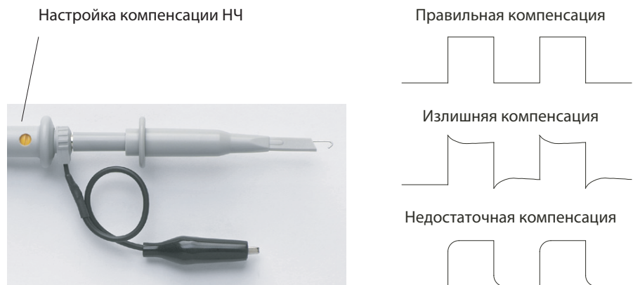
Рис. 4 Низкочастотная компенсация пробника
