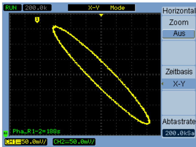
Abbildung 15 X-Y-Anzeigeformat mit Out-of-Phase-Signalen
