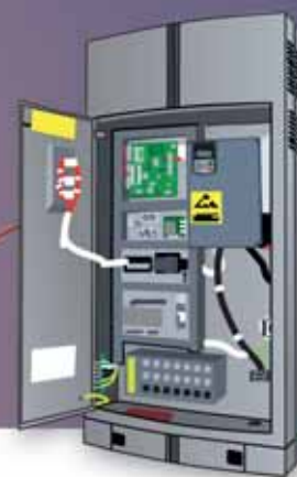
Quadro di Comando dell'Ascensore
