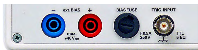
Imagen 4.2: Vista de la sección de la parte trasera del equipo con porta fusibles
