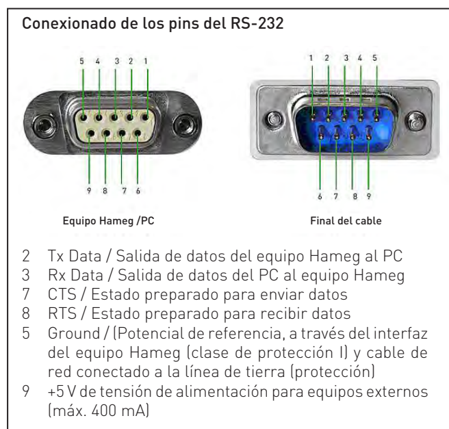
Imagen 8.1: Conexionado de los pins del RS-232
