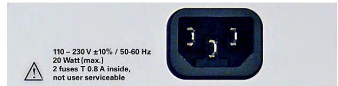
Imagen 4.1: Vista del cajetín de conexión con serigrafía de datos e indicaciones
