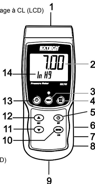
**Remarques :** les articles 6, 7 et 8 sont localisés derrière le couvercle du compartiment s'enlevant sur le côté droit de l'instrument de mesure.
