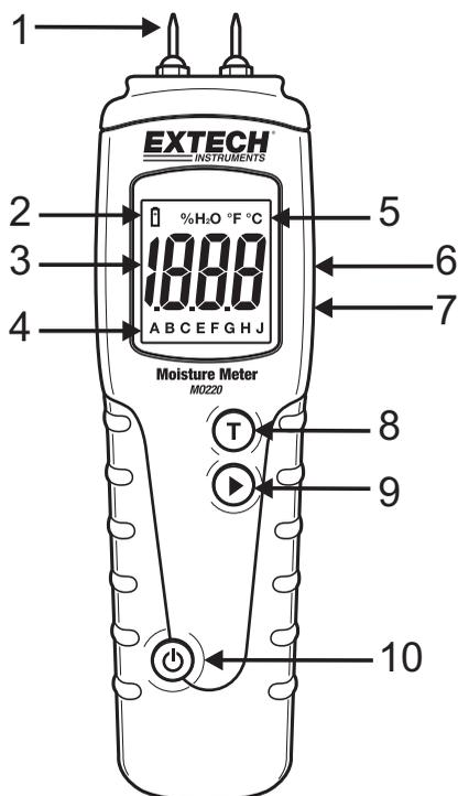
**MISE EN GARDE** : Les broches des électrodes de mesure sont très acérées. Manipulez l'appareil avec précaution. Recouvrez les broches avec le couvercle de protection lorsque vous n'utilisez pas l'appareil.
