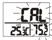
**NOTA:** Calibrazioni a un punto sono permesse. Per calibrare solo al 33%, premere **CAL/Esc** e uscire quando la calibrazione al 33% è completa. Per calibrare solo al 75%, premere **MODE/▲** nei 5 minuti in cui si inzializza la calibrazione al 33%.
