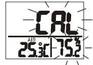
**ANMERKUNG:** Einzelpunktkalibrierungen sind möglich. Um nur 33% zu kalibrieren, drücken Sie **CAL/Esc** und beenden Sie, wenn die 33%-Kalibrierung vollständig ist. Um nur 75% zu kalibrieren, drücken Sie **MODE/▲** innerhalb von 5 Minuten nach der 33%-Kalibrierungs-Initialisierung.
