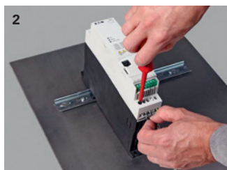
2 Podłączenie głównych torów prądowych (kable ekranowane).
