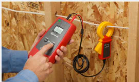
Gdy nie można uzyskać dostępu do niez izolowanego przewodnika, dodatkowe cęgi sygnałowe pozwalają indukować sygnał.
