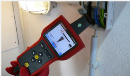
Zdejmij pokrywę puszki przyłączeniowej, by móc śledzić zasilane i niezasilane przewody.
