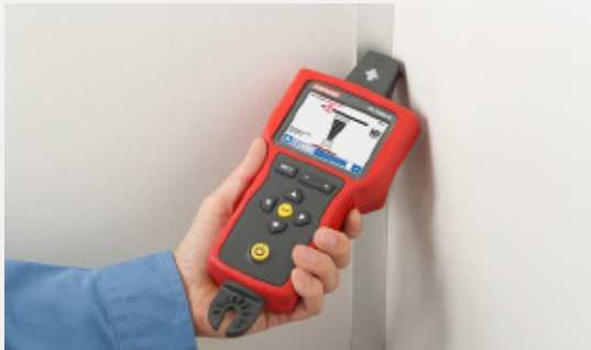
Traçage de câbles dans des zones difficiles d'accès avec la pointe du capteur.
