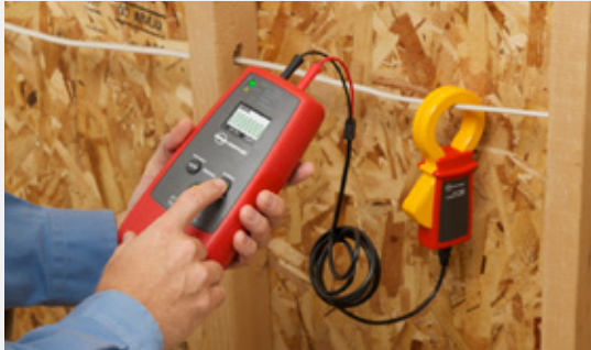
Induction de signal avec la pince de signal en l'absence de conducteur dénudé.
