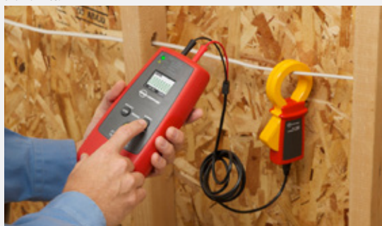
Signál indukovaný signálovými kleštěmi se používá, když není k dispozici obnažený vodič.
