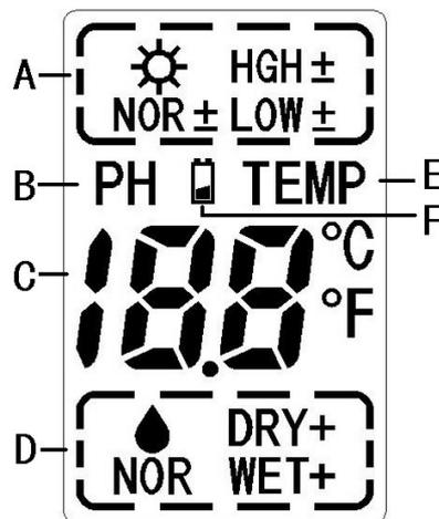
A. Área de visualización de intensidad de luz solar: 9 niveles: BAJO-, BAJO, BAJO+, NOR-, NOR, NOR+, ALTO-, ALTO, ALTO+, cada uno aumentando en cantidad y calidad. BAJO- significa un ambiente extremadamente tenue. ALTO+ significa un ambiente extremadamente brillante.
