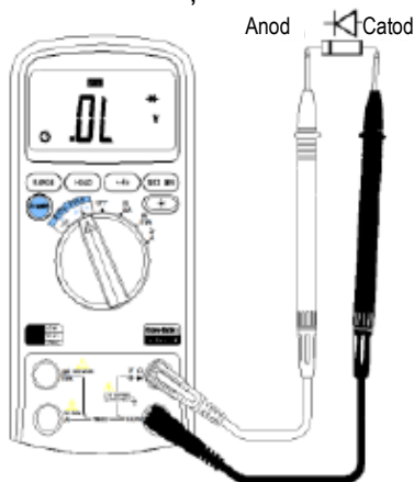
Ilustrația 3-5. Testul diodei
