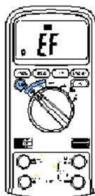
Obrázek 3-2. Bezkontaktní vyhledávání elektrického pole
