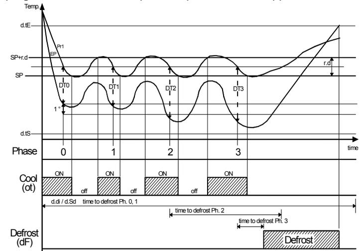
esempio funzionamento "dynamic defrost intervals system" con riduzione "d.dd" = 40 % e fine sbrinamento per temperatura.
