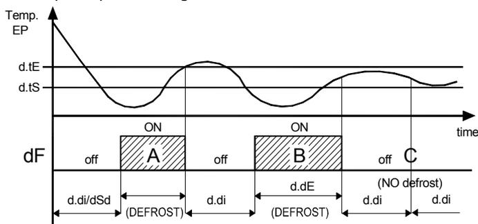
*Esempi di fine sbrinamento: lo sbrinamento indicato come A termina per raggiungimento della temperatura "d.tE", lo sbrinamento B termina allo scadere del tempo "d.dE" in quanto la temperatura "d.tE" non viene raggiunta, lo sbrinamento C non avviene in quanto la temperatura è superiore a "d.tS".*
