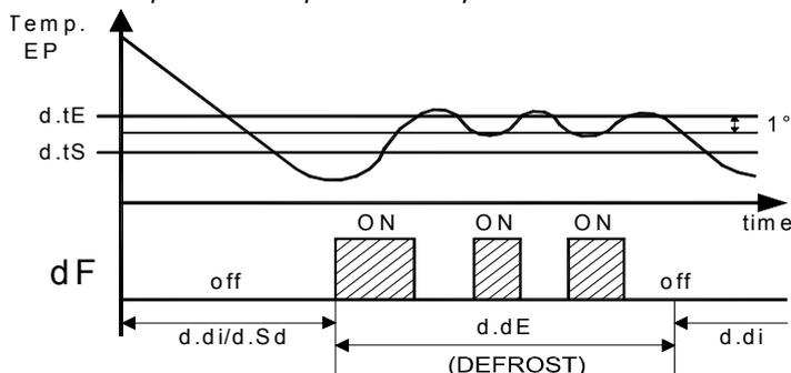
*Esempio di sbrinamento elettrico termostato: lo sbrinamento termina allo scadere del tempo "d.dE". Durante lo sbrinamento l'uscita configurata come dF si accende/spenge come un regolatore di temperatura on-off in funzione di riscaldamento con isteresi di 1° allo scopo di mantenere costante la temperatura di sbrinamento al valore "d.tE" impostato.*
