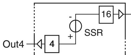
**Niveau logique 0:**  $V_{out} < 0.5 \text{ VDC}$ ;
