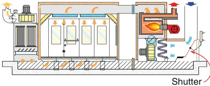
Au cours des phases de séchage et de passivation, l'opérateur est en dehors de la cabine et le système ferme le volet de l'air (shutter) et recycle l'air interne afin de réduire la consommation d'énergie
