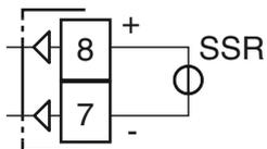
**Niveau logique 0:**  $V_{out} < 0.5 \text{ VDC}$ ;
