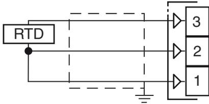
**Circuit d'entrée:** Injection de courant (150  $\mu$ A).
