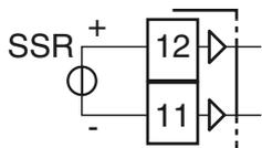
**Niveau logique 0:**  $V_{out} < 0.5 \text{ VDC}$ ;
