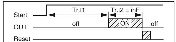
Départ différé à la mise sous tension avec un temps de retard et un temps «fin de cycle».
