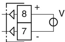
**Sortie V:**  $0/2 \dots 10 \text{ V}$ , isolée,  $R_L \text{ min.} : 500\Omega$ .
