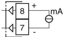
**sortie mA :**  $0/4 \dots 20 \text{ mA}$ , isolée,  $R_L \text{ max. } 600\Omega$ .
