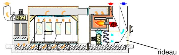
Pendant les phases de passivation et d'essiccation de la peinture, l'opérateur est à l'extérieur de la cabine et le système ferme la vanne de l'air extérieur et recycle l'air interne (déjà chaud) pour réduire la consommation d'énergie.
